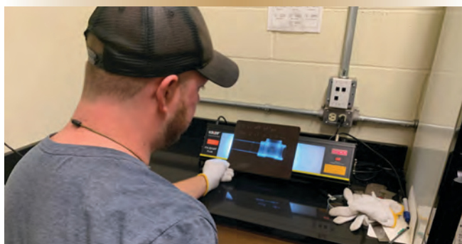
Le technicien en gammagraphie Scott Sanford examine le film radiographique d'un raccord de tuyau à l'Installation de maintenance de la Flotte Cape Scott.
