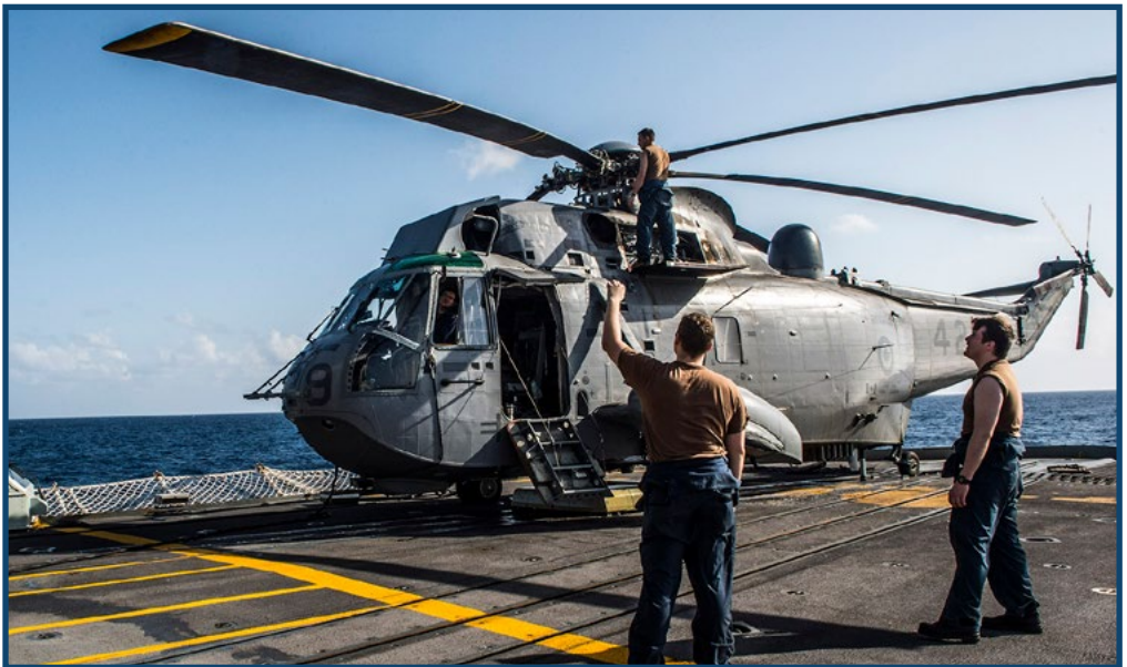
Des membres du détachement aérien du Navire canadien de Sa Majesté ATHABASKAN effectuent des contrôles de maintenance sur les pales du rotor de l'hélicoptère CH-124 Sea King pendant l'opération CARIBBE, le 4 mai 2015.
