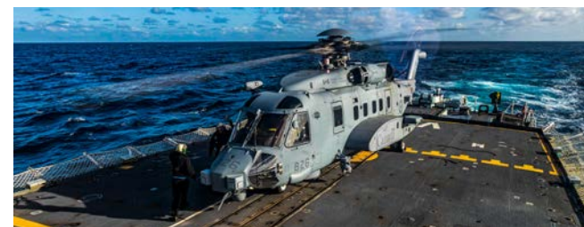
Le CH-148 Cyclone utilise le même type de système d'appontage et d'arrimage (trappe à ours) que son prédécesseur pour faciliter son appontage et son décollage pendant le pilonnement du navire. (Photo : Caméra de combat des FC)
