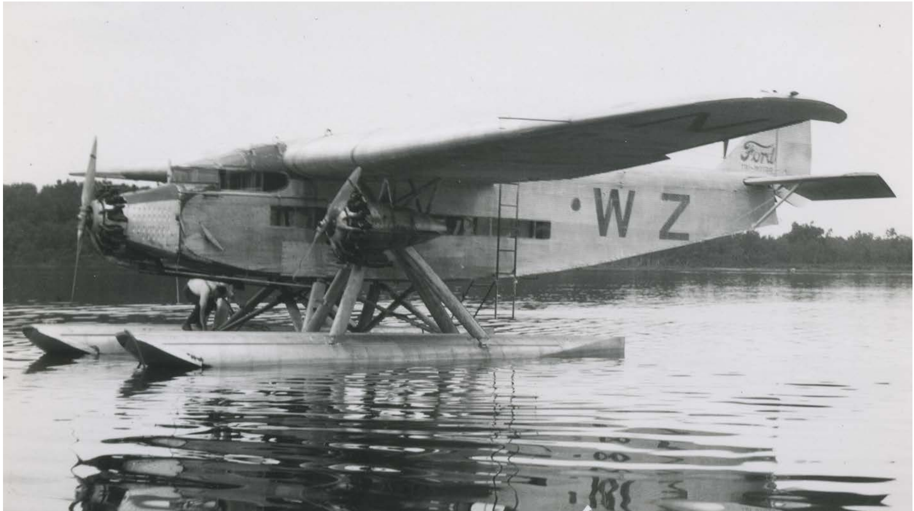
En service dans l'ARC, le Ford TriMotor a été monté sur des roues, des skis et des flotteurs comme on le voit sur cette photo. (Photo : ARC, HC3043)
