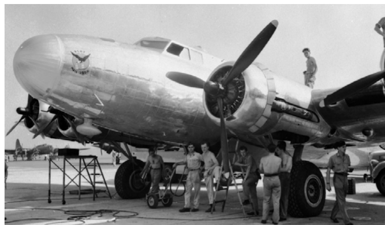
Cette photo prise en août 1944 montre la Forteresse volante B-17 de Boeing de l'ARC portant le matricule 9205 dans sa forme finale modifiée. L'appareil a été décapé pour l'alléger, le nez est doté d'un compartiment de fret avec une porte articulée et d'autres modifications intérieures ont été effectuées afin de faciliter les opérations de transport. (Photo : ARC)
