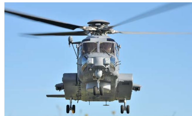
Le CH-148 Cyclone possède de nombreux capteurs, dont certains sont visibles à l'avant de l'hélicoptère sur la photo, qui sont reliés notamment à la défense antimissile et à une caméra infrarouge à balayage frontal. (Photo : ARC, SW2013 0348 16)
