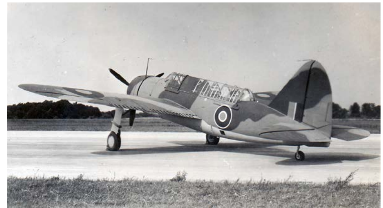
L'un des types d'avions les moins connus en service au sein de l'ARC, le Bermuda de Brewster, était un gros monomoteur. Ces appareils peu nombreux étaient surtout utilisés pour remorquer des cibles et à des fins d'essais. (Photo : ARC)
