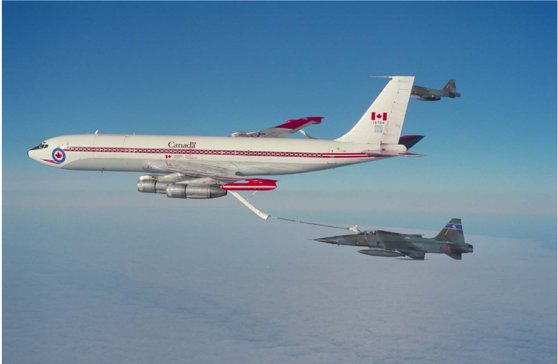
L'acquisition des premiers Boeing CC-137 remonte à 1970. Ils ont été utilisés par les FC comme avions de transport stratégique et, tel qu'on peut le voir sur la photo, en tant qu'avion ravitailleur pouvant ravitailler simultanément jusqu'à deux chasseurs en vol. La flotte de CC-137 a été mise hors service à l'été 1996. (Photo : ARC, PCN72-41)
