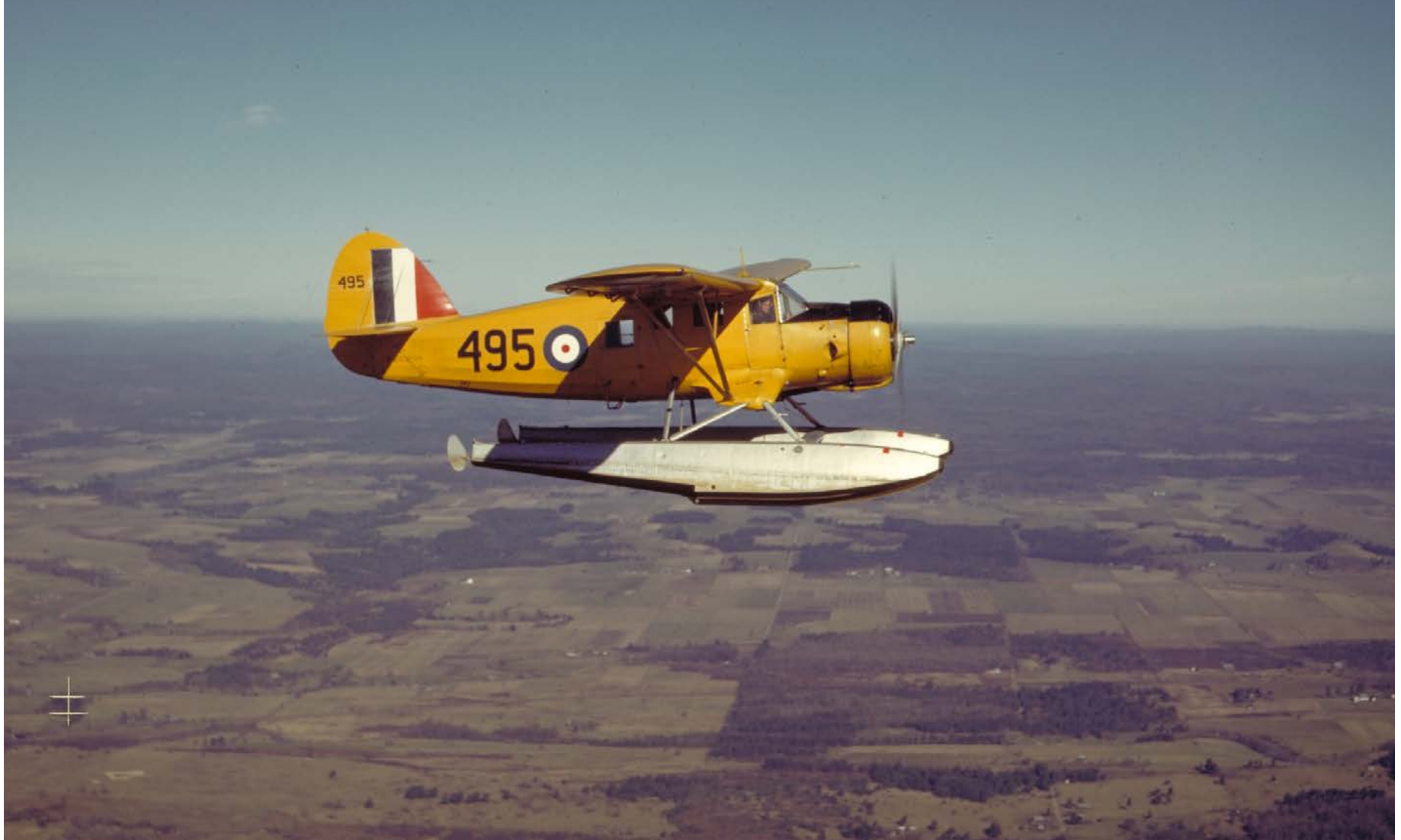
Les avions Norseman de Noorduyn étaient souvent montés sur flotteurs, comme on peut le voir sur cette rare photo en couleur de l'appareil 495 Mk IVW. (Photo : ARC, PC2490)
