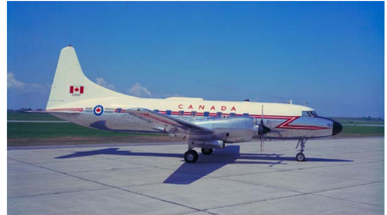
La configuration révisée de l'avion de transport de personnalité très importante CC-109 Cosmopolitan, équipé de turbopropulseurs Allison T-56 (Photo : ARC, UPC 74-830)
