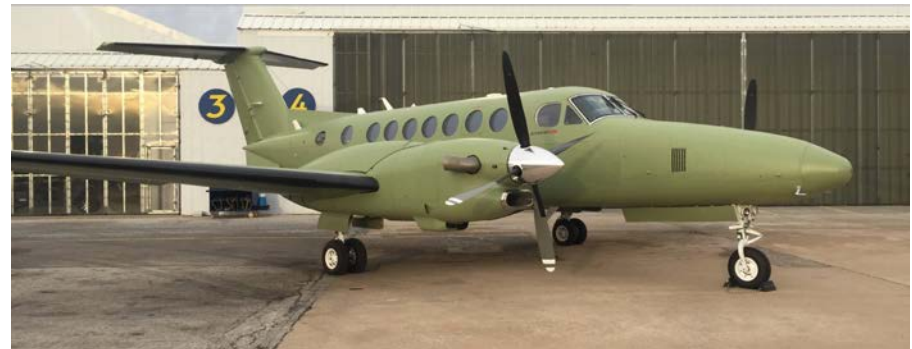
Le gouvernement canadien a également conclu un contrat visant l'acquisition de trois King Air 350 à rayon d'action accru, équipés de capacités avancées en RSR, pour assurer le soutien des Forces d'opérations spéciales du Canada. Voici un des aéronefs en question sur lequel l'équipement de mission spécial n'a pas encore été installé. (Photo : FC)
