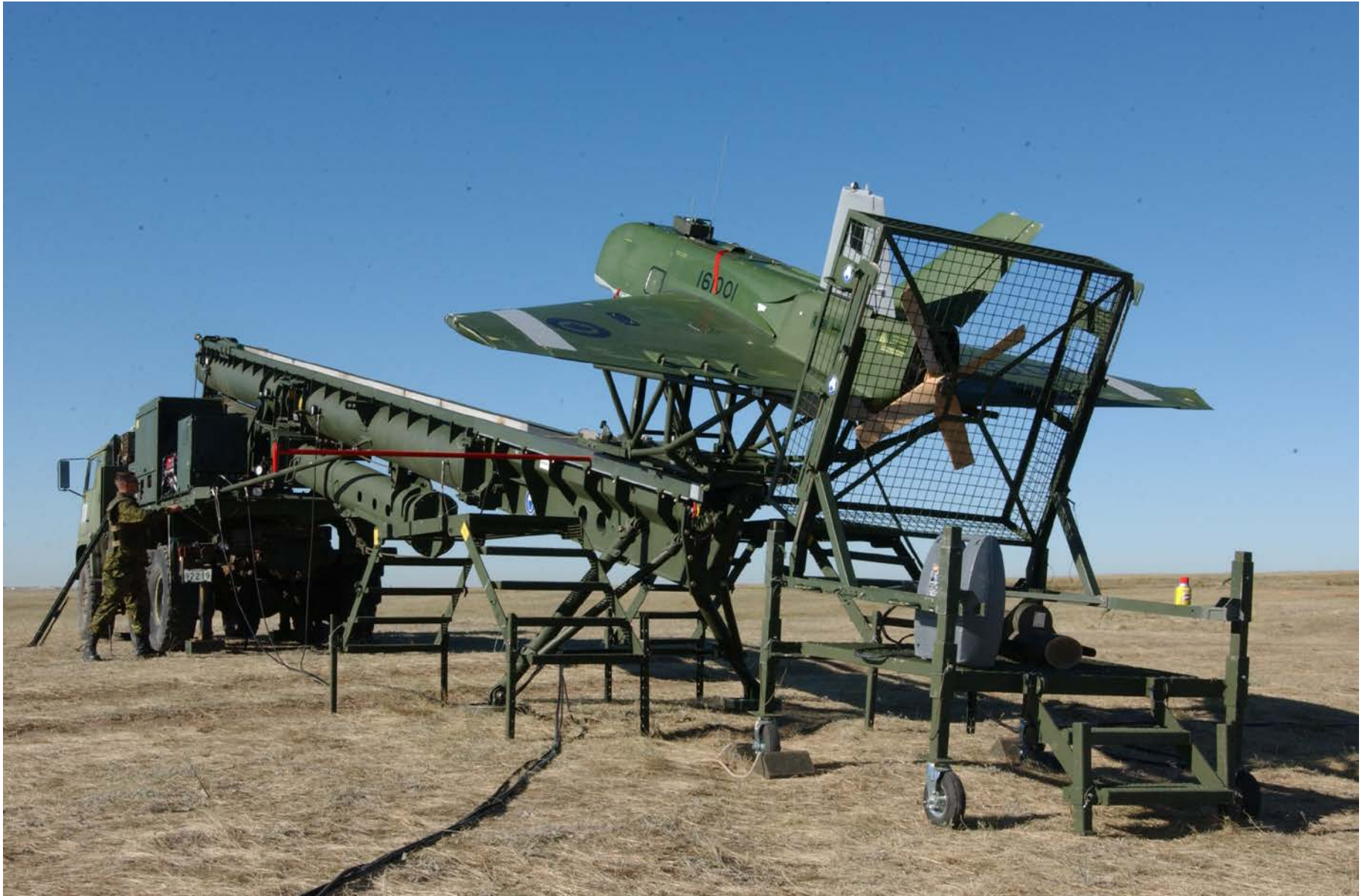
L'UAV CU-161 Sperwer ainsi que son système de lancement qui ont été déployés dans le cadre de l'Op ATHENA en Afghanistan. (Photo des FC)
