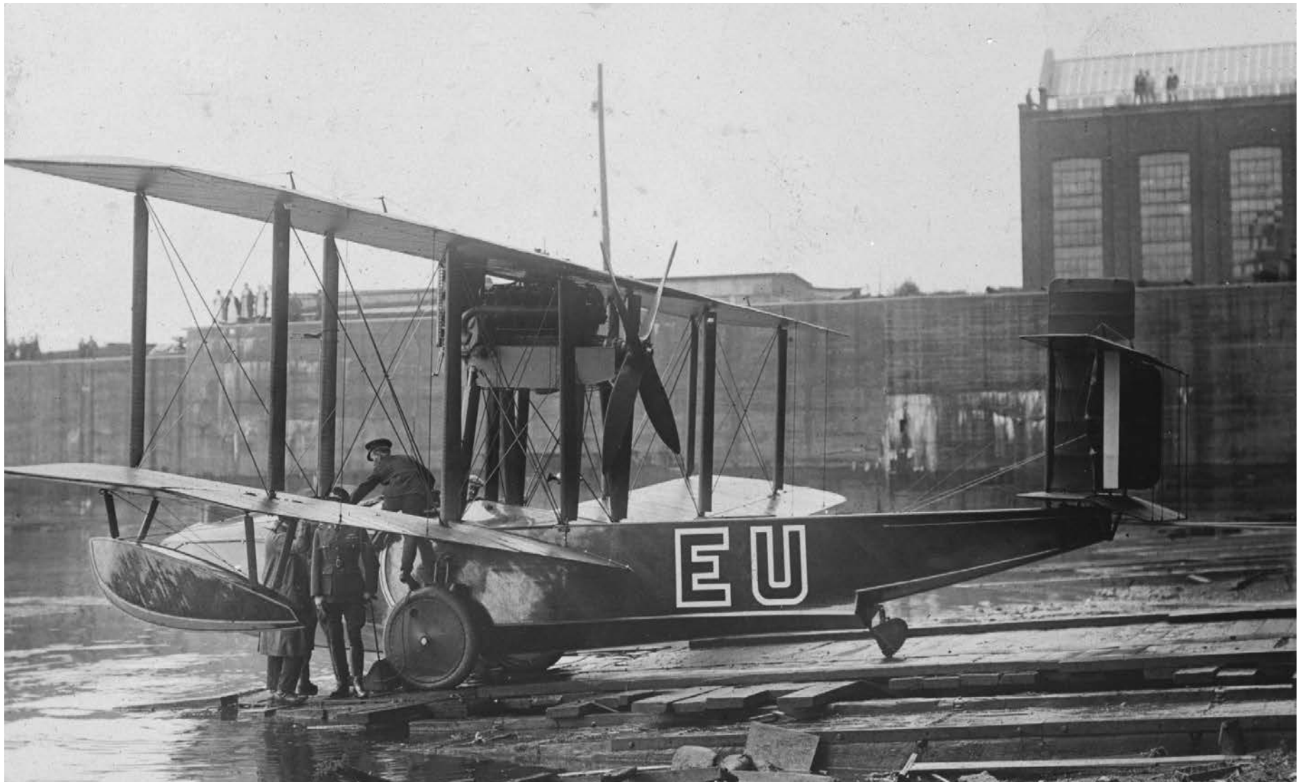
Le Viking de Vickers immatriculé G-CYEU. L'ARC a choisi le Viking de Vickers pour remplacer l'hydravion à coque HS-2L de Curtiss. L'équipage était assis dans un poste de pilotage ouvert, et l'ARC a demandé l'ajout d'un autre poste pour loger un appareil photographique dans la partie avant de l'aéronef. Le choix s'est surtout arrêté sur la version équipée d'un moteur Rolls-Royce par souci d'économie, mais, à cause de cette décision, le Viking IV manquait considérablement de puissance pour un aéronef de cette taille et de cette masse. (Photo : ARC, RE-13633)
