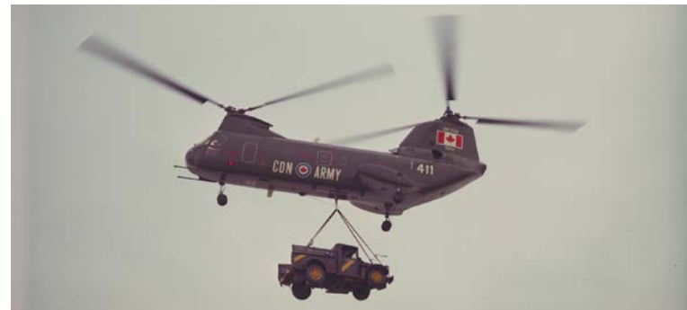
Un CH-113 Voyageur dans la configuration utilisée par l'Armée de terre, qui est dépourvue des grosses nageoires rouges que l'on retrouve à l'arrière du CH-113 Labrador. (Photo : Armée de terre, ZK2054)
