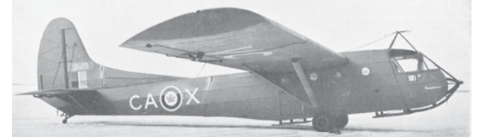
Cette photo d'un planeur CG-4A de Waco portant la livrée de l'ARC, prise à Gimli au Manitoba, montre bien le profil des ailes. (Photo : ARC)
