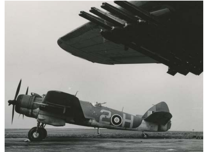
Un autre Bristol Beaufighter (NE355) affecté au 404 e Escadron (ARC) et armé de roquettes et de canons, en 1944. (Photo : ARC)
