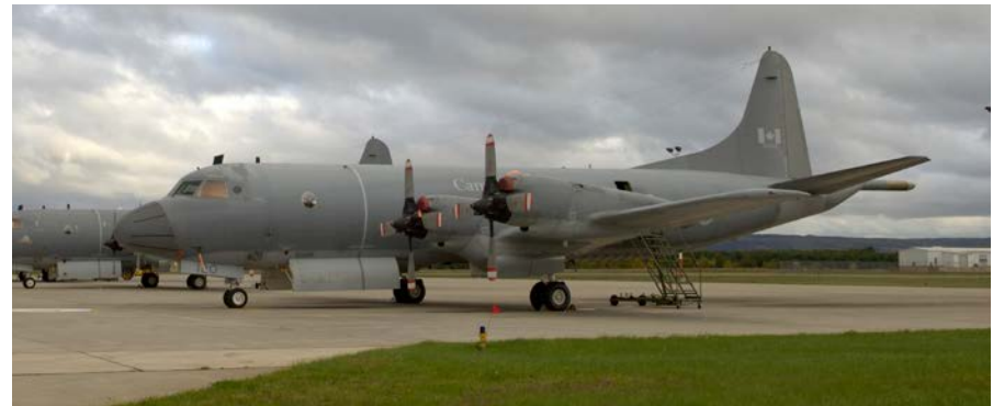
Le CP-140A Arcturus n° 140120 à la 14 e Escadre Greenwood. Une différence visuelle entre le CP-140 et le CP-140A était l'absence de nacelles de MSE en bout d'aile, comme en témoigne cette photo. (Photo : ARC, SWC94-793-29)
