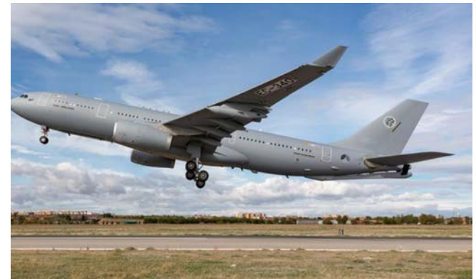
Basé sur le célèbre avion de ligne commercial A330-200 d'Airbus, le A330 MRTT est la variante militaire adaptée au transport stratégique et aux capacités de ravitaillement en vol. La photo montre un A330 MRTT appartenant à la Royal Netherlands Air Force. (Photo : GracieuSeté de Airbus Defence and Space)
