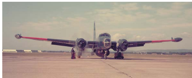
Cette photo montre l'un des premiers modèles de Neptune de l'ARC. Il n'y a pas de nacelles de moteurs à réaction J34 à l'extérieur des moteurs à pistons réguliers. (Photo : ARC, PCN-1592)
