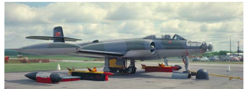
Photo intéressante du CF-100 Mk 4B ainsi que de sa charge potentielle de roquettes et de missiles. Le cône de nez du radar et le panneau de la partie supérieure du fuselage ont été remplacés par des composants de plexiglas afin que l'équipement radar soit visible. (Photo : ARC, PCN-418)
