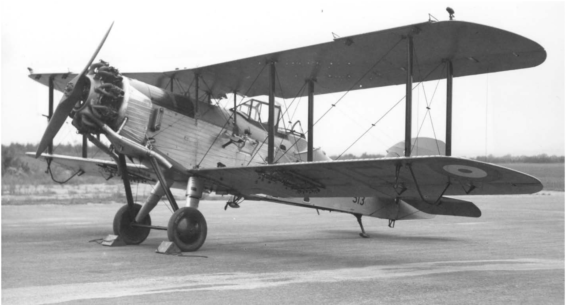
Le Wapiti 513 fait partie du lot original de six appareils achetés par l'ARC. Cet avion affecté aux opérations du 3 e Escadron (B) avait hérité, par erreur, de la livrée des avions d'entraînement, c'est-à-dire les ailes et le fuselage arrière entièrement jaune, tandis que le fini des autres surfaces demeurait en métal naturel. Remarquer l'ajout d'un poste de pilotage fermé dans le but de faciliter le déroulement des opérations hivernales. (Photo : ARC)
