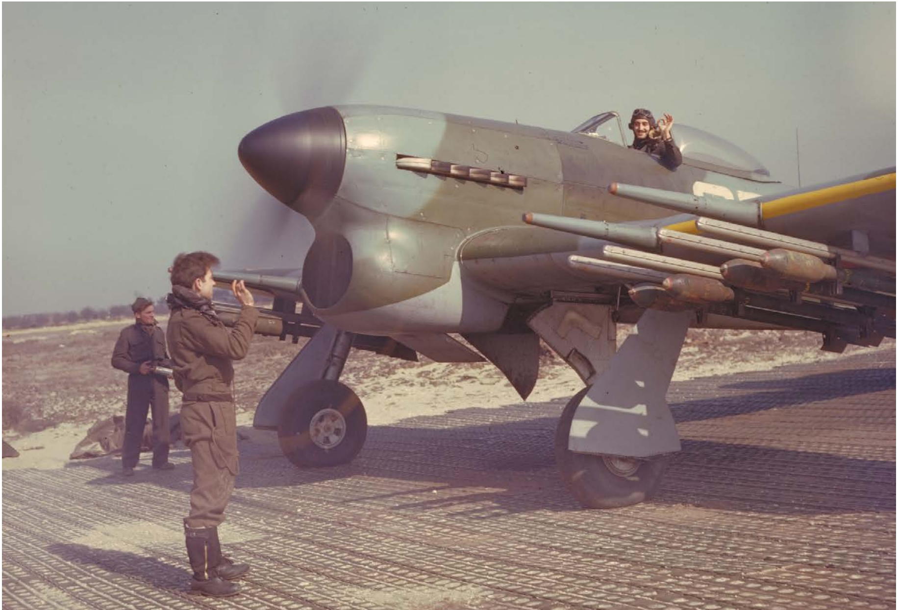
Un Typhoon affecté à l'ARC est guidé au sol afin de le mettre en valeur pour cette rare photo couleur. Il est équipé de roquettes. Remarquer l'aire de trafic recouverte de tôles d'acier perforées. (Photo : ARC, PC2467)
