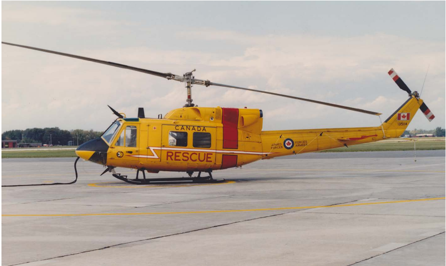
Le CH-135 Twin Huey était également employé dans des opérations de recherche et sauvetage (SAR). Dans l'image ci-jointe, il est équipé du dispositif Wire Strike Protection System (WSPS) de conception canadienne, qui consistait en des coupe-fils montés dans le haut et dans le bas du pare-brise. (Photo : FC, PCN 82-121)
