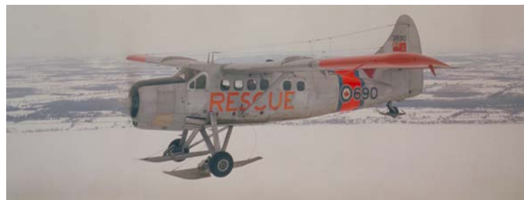
L'avion de transport utilitaire CSR-123 Otter pouvait être muni de roues, de skis ou de flotteurs. Ces photographies montrent les trois configurations du type. (Photos : ARC, PC-211, RT118, et PCN-79-182)
