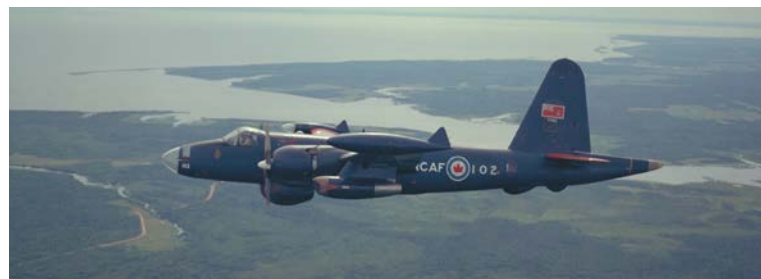
Dans cette photo du Neptune n° 24102 de l'ARC, les nacelles de moteurs à réaction J34 sont clairement visibles sur l'aile extérieure. (Photo : ARC, PCN-1885)
