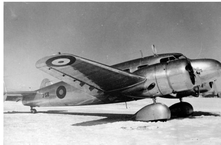
Vue au sol du Barkley Grow de l'ARC, sur laquelle le train d'atterrissage fixe est visible. (Photo : Musée de la Force aérienne de Comox)
