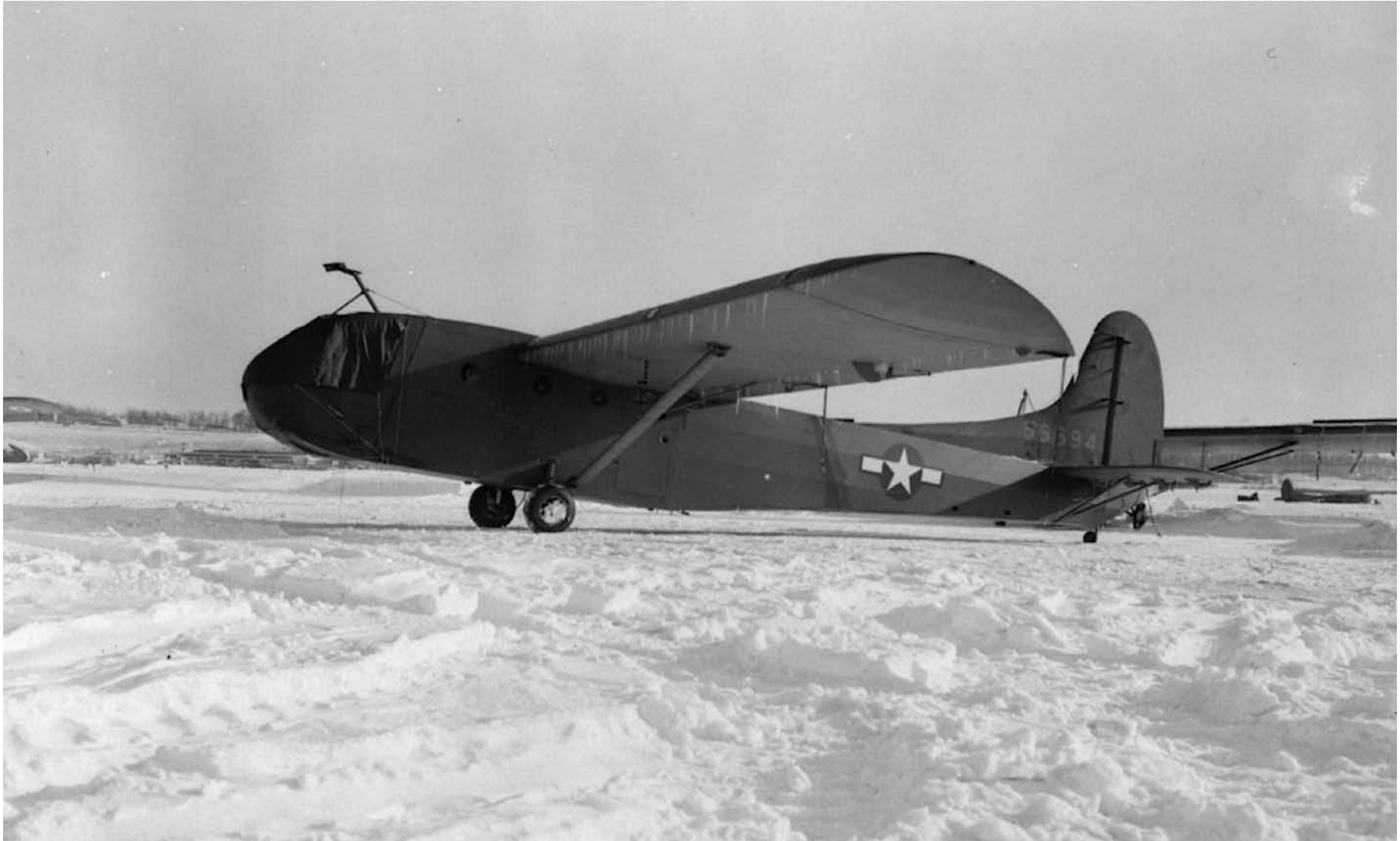
Le Canada a fait l'acquisition de ce planeur américain CG-15 de Waco aux fins d'essais. Cette photo hivernale présente bien la voilure modifiée et les autres améliorations apportées au type. (Photo : Bibliothèque et Archives Canada, PA65385)
