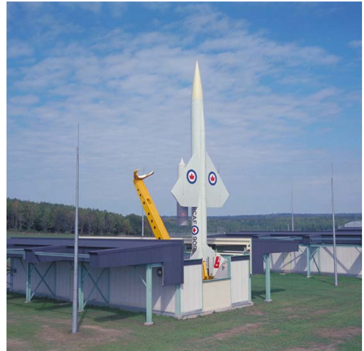
La photo ci-dessus montre un missile BOMARC rangé dans un hangar. Ci-dessous, un missile qui a été érigé et qui est prêt au lancement; le bras érecteur est en train de se retirer. (Photos : ARC, PCN-4077 et CPN-4083)
