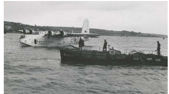
Le Sunderland de Shorts ML778, affecté au 422 e Escadron de l'ARC, se prépare à recevoir du carburant d'un chaland de ravitaillement de la RAF. (Photo : ARC, PL-41249)
