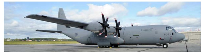
Le CC-130J Hercules est un avion considérablement redessiné qui n'a que quelques points en commun avec les autres Hercules de la flotte d'avions de transport des FC. Vu de l'extérieur, il est presque identique à ses prédécesseurs (à l'exception des hélices à six pales), mais l'intérieur a été pratiquement tout réaménagé avec une nouvelle avionique et des commandes de vol électriques entièrement revues. (Photo : FC, FA2011-0041-18)
