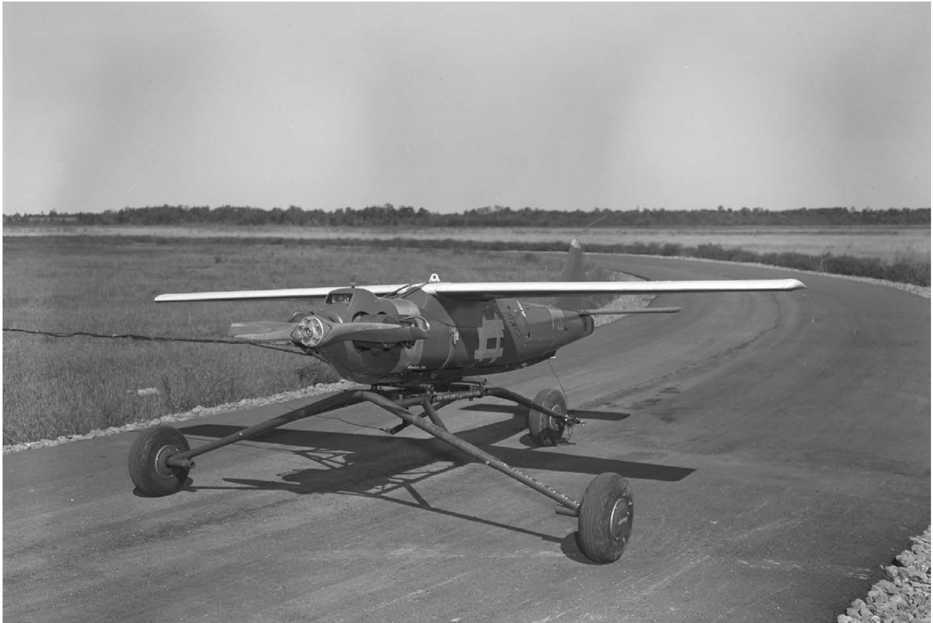
Ces trois photos montrent le Radioplane OQ-19, un drone-cible peu connu mis à l'essai par l'ARC. (Photos : ARC)
