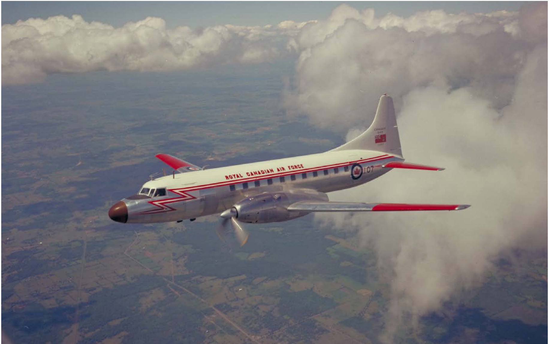
La configuration d'origine de l'avion de transport de personnalité très importante CC-109 Cosmopolitan, qui comprend des turbopropulseurs Napier Eland 504. (Photo : ARC, PCN-993)
