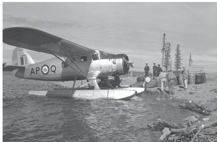
Le Norseman de Noorduyn était un avion de conception robuste et fiable. Il a été utilisé par l'ARC tout au long de la Deuxième Guerre mondiale, mais, après la guerre, ses derniers modèles (comme ce Mk VI exploité par le 413 e Escadron) se sont avérés l'élément de base des unités de recherche et de sauvetage. (Photo : ARC, PC2490)
