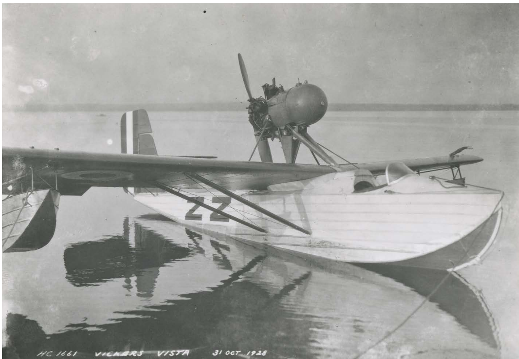
Ceci est le seul Vista de Canadian Vickers, matricule G-CYZZ, amarré pour mettre sa coque à l'essai. (Photo de l'ARC HC-1661)
