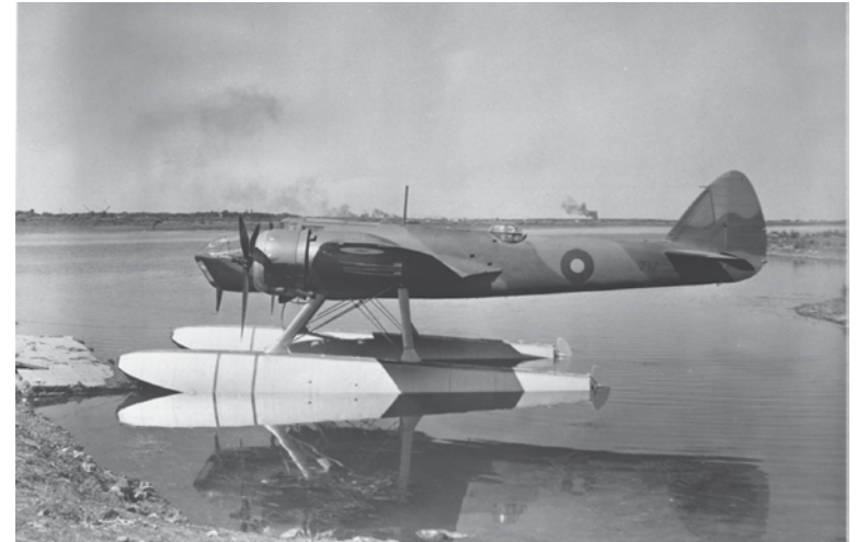
Le Bristol Bolingbroke portant le matricule 717 du 5 e Escadron de l'ARC lors d'un essai sur des flotteurs. Les essais ont été fructueux, mais aucun autre aéronef n'a été modifié. (Photo : ARC, PL140864)
