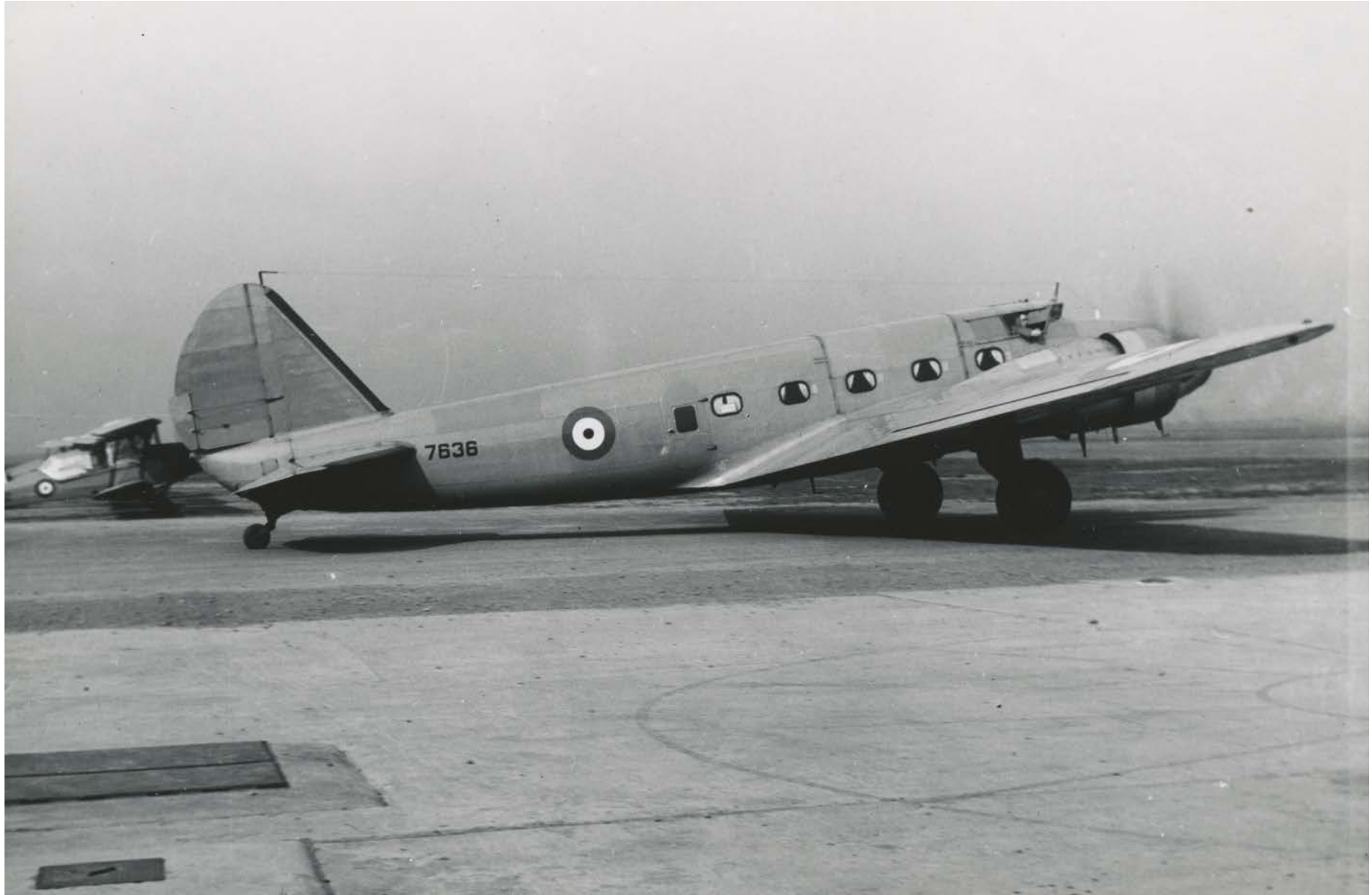
Le modèle 247-D de Boeing portant le matricule 7636 de l'ARC en train de circuler au sol à côté d'un Tiger Moth construit par de Havilland. Remarquez l'inclinaison distinctive vers l'avant du parebrise du poste de pilotage que l'on retrouvait sur certains appareils. (Photo : ARC)
