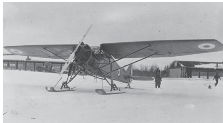
Certains Hawk Moth de l'ARC, construit par De Havilland, étaient montés sur skis, comme cet avion portant le matricule G-CYVM posé au Camp Borden. (Photo : ARC, RC2429)
