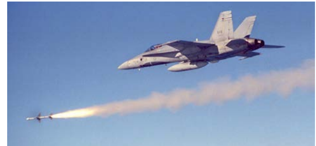
Ce CF-188 Hornet fait le tir d'essai d'un missile AIM-7 dont la cible est un drone. (Photo : FC)
