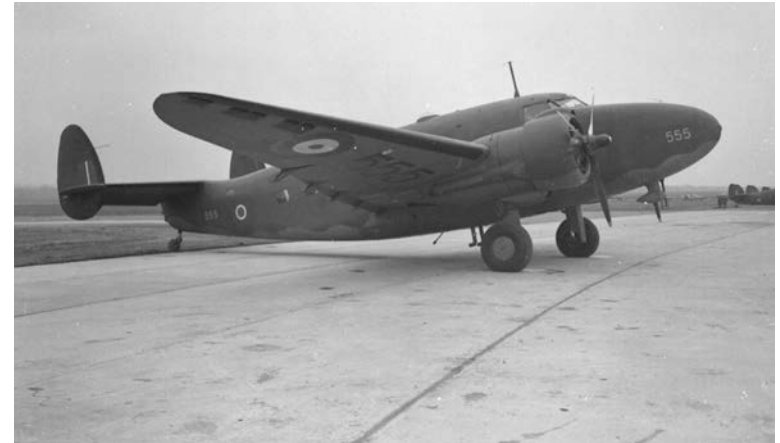
Une photo prise sur l'aire de trafic du Lockheed Lodestar n° 555 de l'ARC dans la livrée de camouflage. Vers la fin de la guerre, les aéronefs comme celui-ci étaient décapés afin de les alléger. (Photo : ARC, RE881-1)
