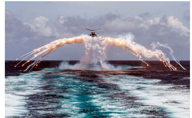
La flotte d'hélicoptères CH-124 Sea King était équipée de distributeurs de paillettes et de leurres comme moyen de défense. La photo présente une mise à l'essai de ce système. (Photo : ARC, ET2014 7218 01)
