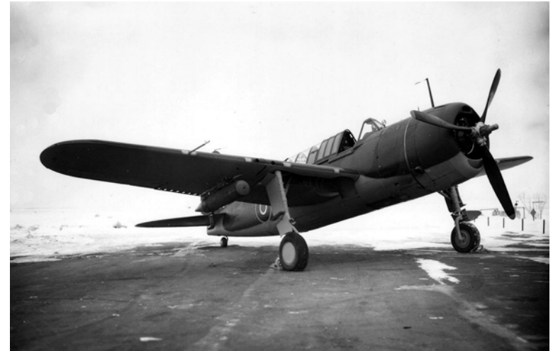
L'un des types d'avions les moins connus en service au sein de l'ARC, le Bermuda de Brewster, était un gros monomoteur. Ces appareils peu nombreux étaient surtout utilisés pour remorquer des cibles et à des fins d'essais. (Photo : ARC)
