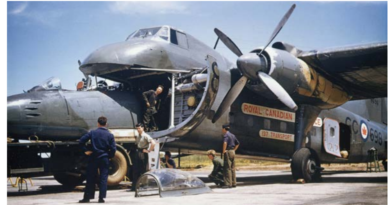
Le Bristol Freighter de l'ARC pouvait transporter un F-86 Sabre démonté des bases de l'ARC en Europe jusqu'aux établissements de réparation et de révision situés à Prestwick, en Écosse. (Photo : British Columbia Aviation Museum)
