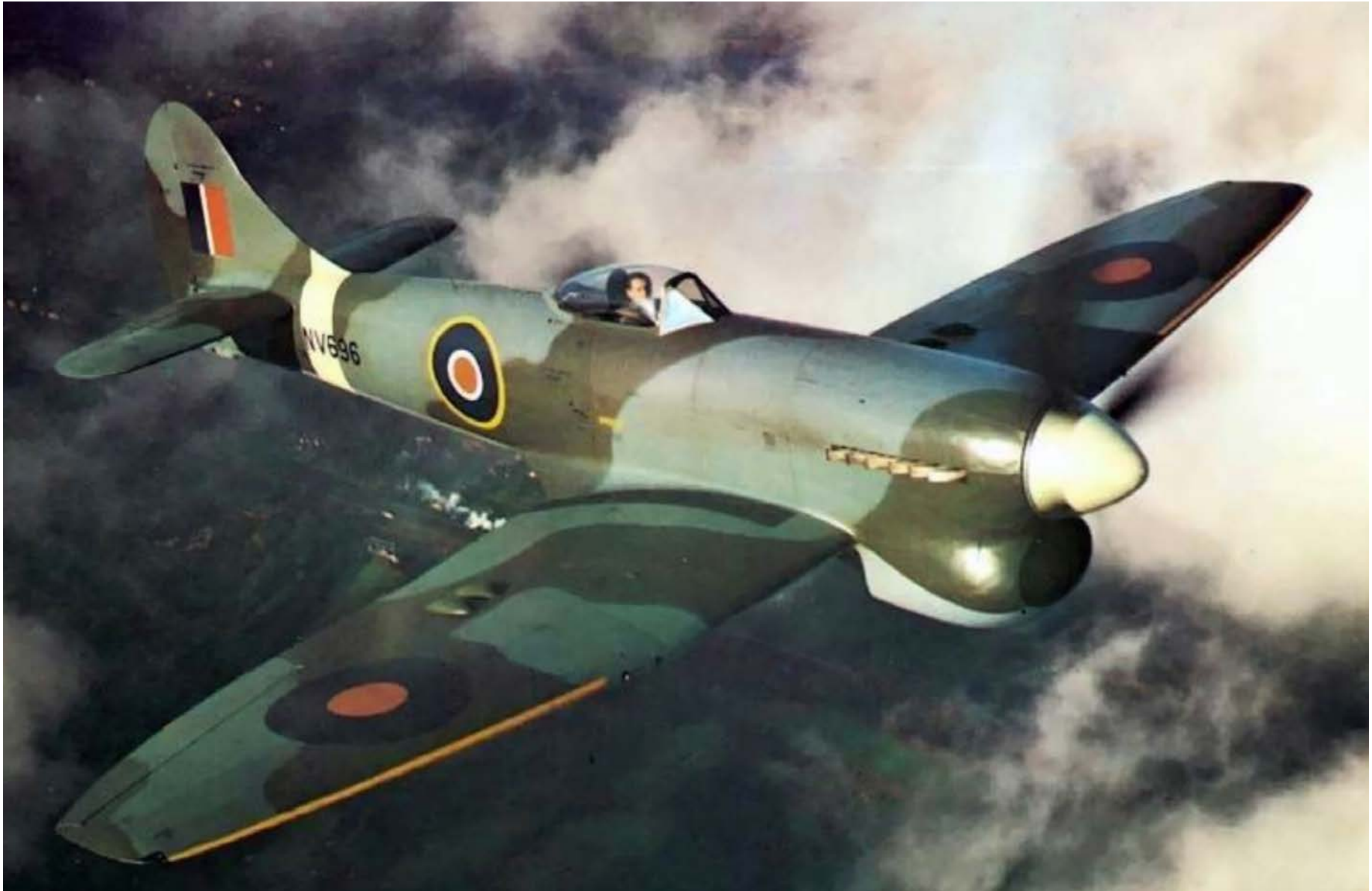
Voici une vue d'un modèle de production avancée de Hawker Tempest Mk V illustrant l'héritage du Typhoon, avec sa verrière en « goutte d'eau » distinctive et son radiateur en mentonnière. (Photo : ARC)
