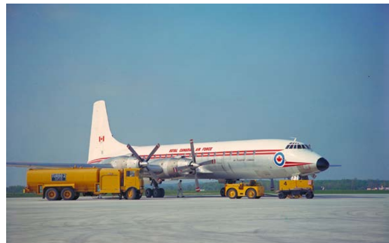
Ravitaillement et autres travaux d'entretien courants d'un CC-106 Yukon portant le suffixe 15927. (Photo : ARC, REC68-718)
