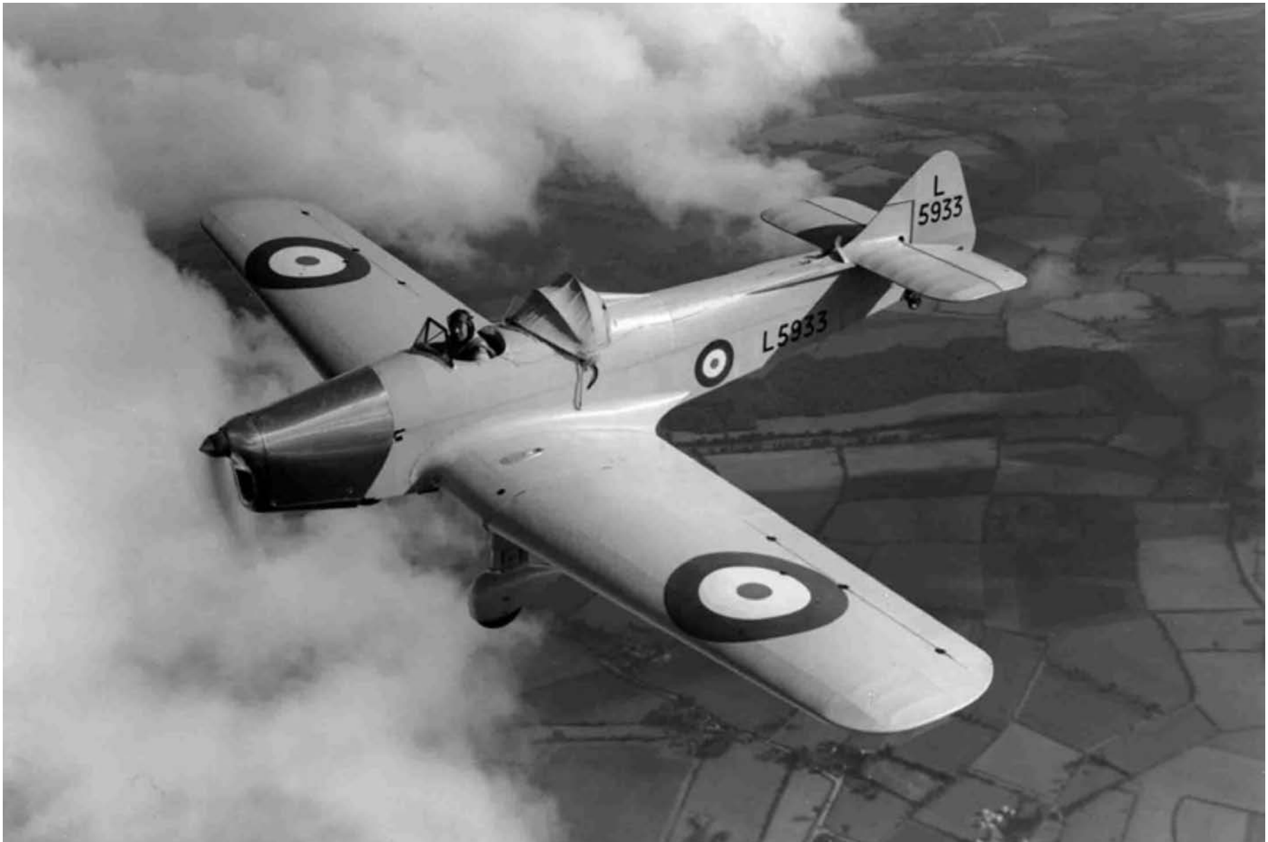
Photo d'un avion-école biplace Miles Magister utilisé par la RAF. Le deuxième siège se trouve sous une capote de pilotage sans visibilité aux fins de vol aux instruments. (Photo de la RAF)
