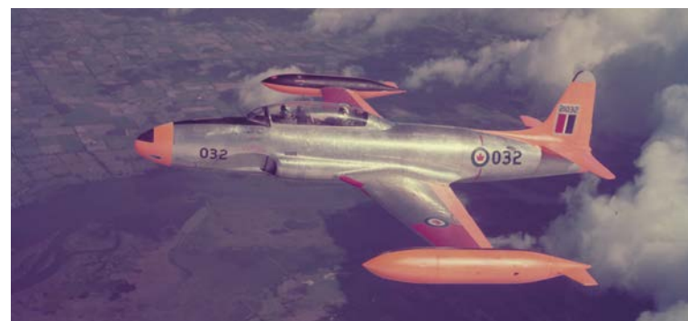
Photo d'un T-33 portant le suffixe 21032 construit par Canadair, prise le 5 septembre 1956. Les marques orange Day-Glo s'estompaient et s'usaient ou s'estompaient; on a donc rapidement décidé d'employer plutôt une peinture rouge lustrée. (Photo : ARC, PC-1971)
