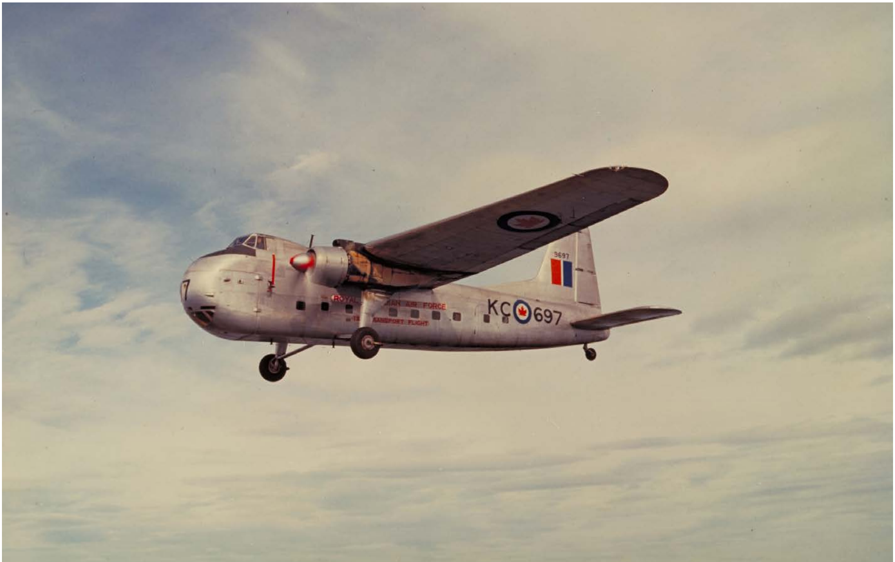
Cette photo aérienne du Freighter de Bristol en vol montre clairement l'allure insolite de cet appareil, avec son fuselage massif et bombé et son train d'atterrissage fixe. (Photo : ARC, PC424)
