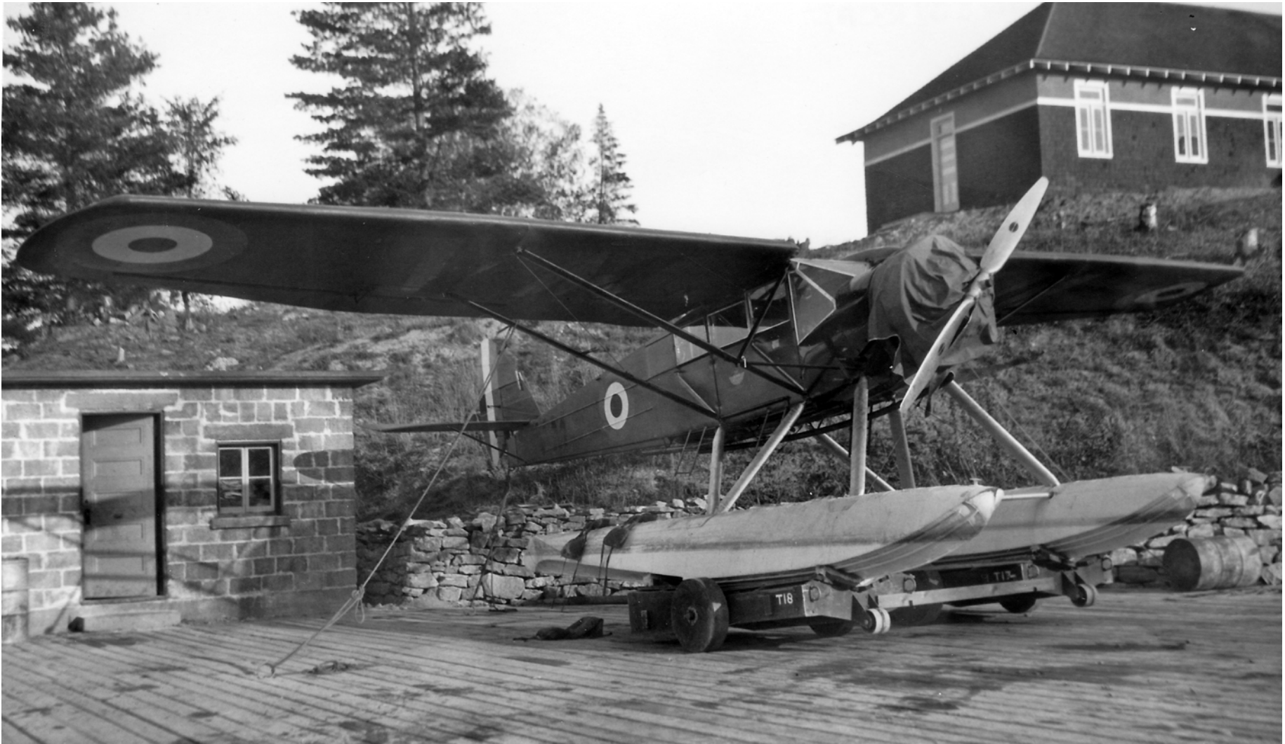
Un Hawk Moth de l'ARC, construit par De Havilland, monté sur flotteurs et posé sur un appareil de halage à terre. Cette configuration a permis de déceler des problèmes structuraux de conception. (Photo : PA62799, Bibliothèque et Archives Canada)
