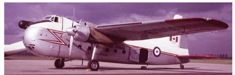
Le Bristol Freighter de l'ARC dans sa forme finale. L'appareil était peint avec un motif non tactique et un radar météorologique avait été ajouté dans le nez. (Photo : ARC)
