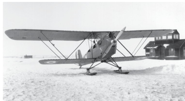
L'avion-école Rambler de Curtiss-Reid avait des lignes très épurées sans nécessiter les haubans d'ailes qui étaient la norme pour la conception d'aéronefs de cette période. (Photo : FC, en haut, et Musée canadien de l'air et de l'espace)
