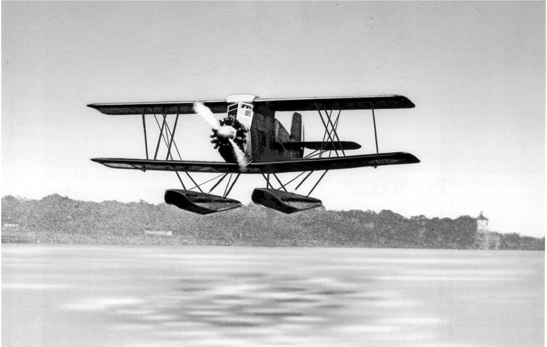
La conception du Vanessa de Vickers a été inspirée par le Stinson, un biplan à cabine fermée construit aux États-Unis. Une des caractéristiques du Stinson qui déplaisait à l'ingénieur en chef canadien de Vickers était son haubanage en fil de fer, qui est classique sur les biplans, mais qui empêche d'accéder facilement à la cabine. Il a donc introduit un nouveau système d'entretoises interplans, que l'on peut clairement voir sur la photo ci-dessus. (Photo : ARC) (Photo : FC)
