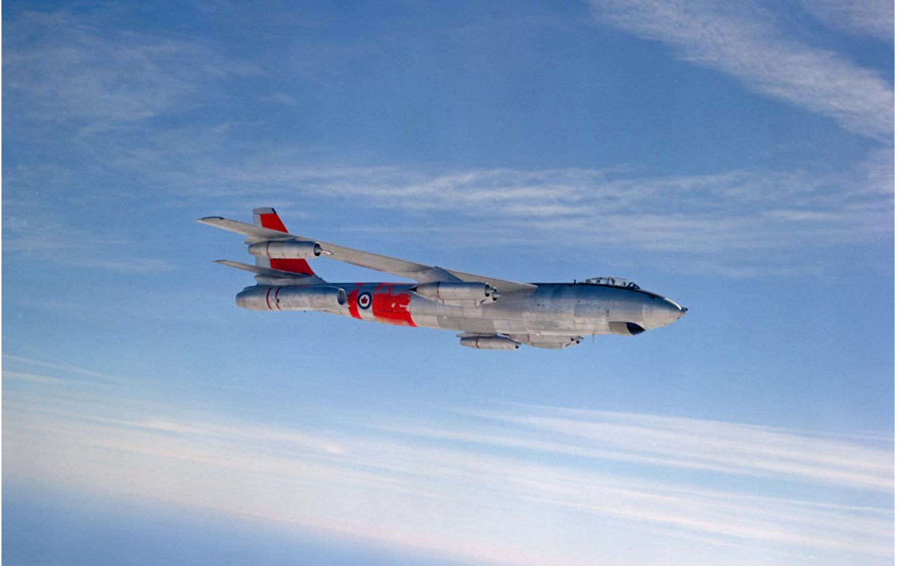
Le seul avion B-47 Stratojet ayant eu une livrée de l'ARC. Remarquer la nacelle d'essai du moteur Iroquois qui est bien visible dans la partie arrière de l'aéronef. (Photo : ARC)
