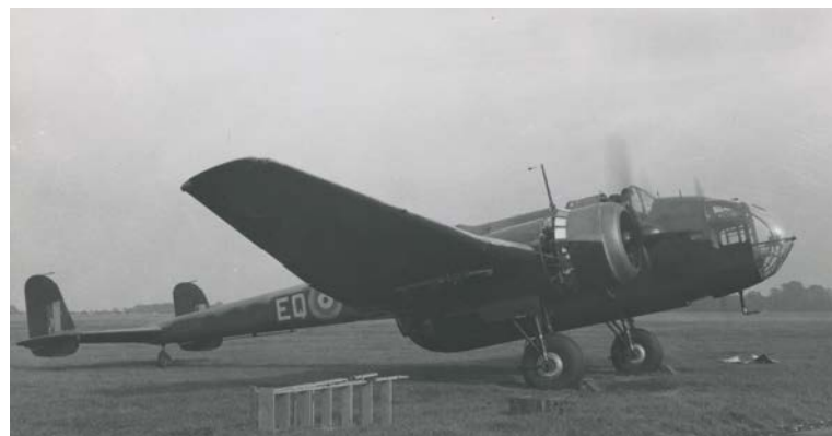
Ce Handley Page Hampden n° AE288 appartenait au 408 e Escadron. L'avion effectue apparemment un point fixe du moteur au sol, comme en témoignent les panneaux de capotage moteur manquants. (Photo : ARC, PL-4715)
