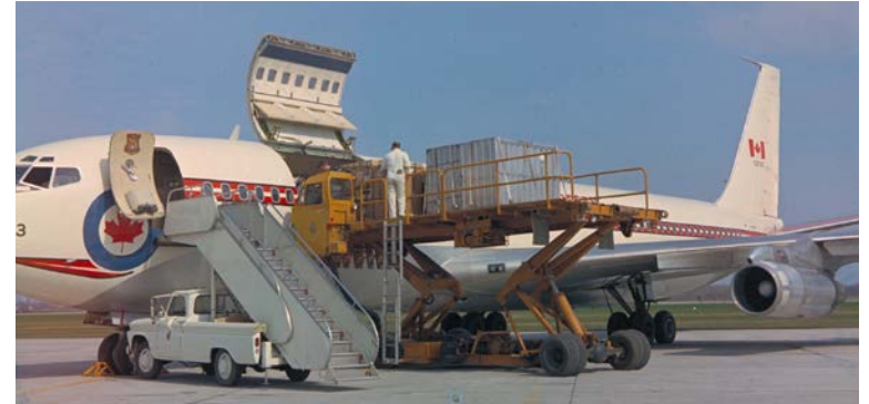
Le Boeing CC-137 de l'ARC servait d'avion de transport stratégique de passagers et de fret, selon les besoins. Le chargement du fret a été facilité par l'installation de grosses portes de soute, comme le montre la photo cidessus. (Photo : ARC, PCN71268)
