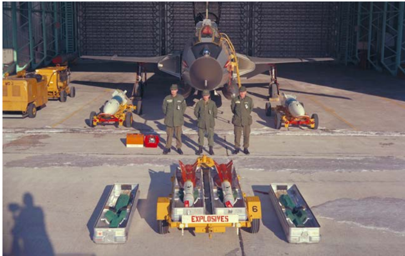
Un CF-101 Voodoo montre son armement et son équipage de chargement alors qu'il est assis dans son hangar d'alerte de réaction rapide. Deux roquettes non guidées AIR-2A Genie capables de transporter une ogive nucléaire de 1,5 kilotonne se trouvent sous les ailes de l'avion tandis qu'au premier plan se trouvent deux missiles à tête chercheuse thermique AIM-4D Falcon.
