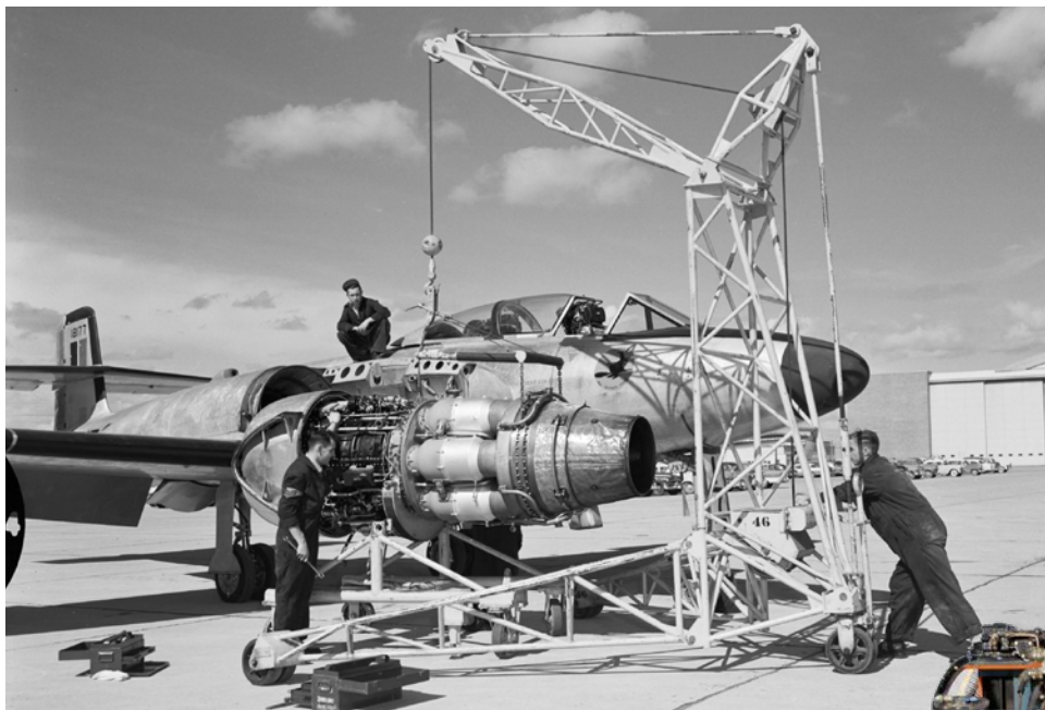
Des techniciens de moteurs d'aviation changent le moteur Orenda d'un CF-100 Mk III appartenant à la 3 UEO des chasseurs tout temps à la Station de l'ARC Cold Lake.
