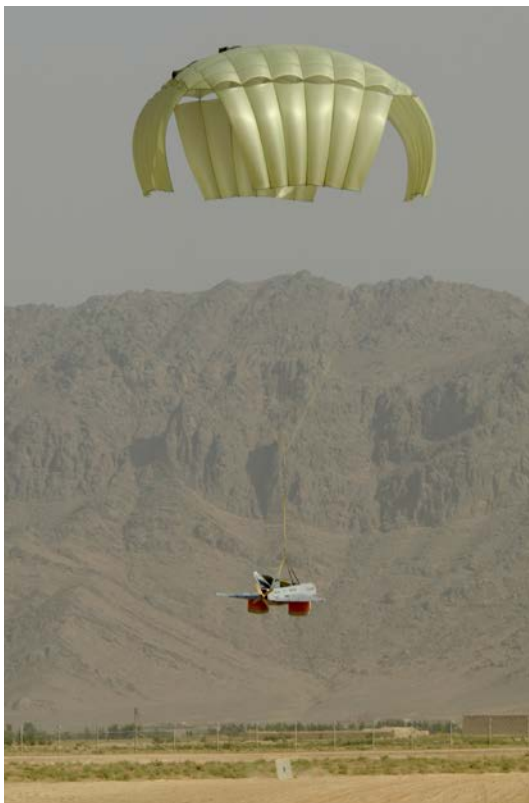
Un UAV Sperwer atterrit sous son parachute aux environs de l'aérodrome de Kandahar après avoir effectué une mission au petit matin du 6 juillet 2006. Les coussins gonflables destinés à amortir son atterrissage sont visibles sous ses ailes.
