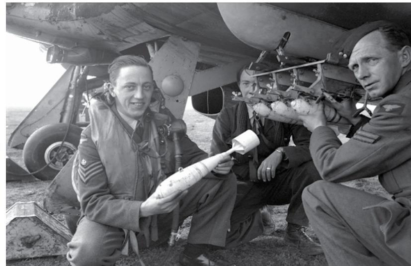
Pendant que deux armuriers de la RAF chargent des bombes d'exercice factices sur son Hawker Hurricane, le sergent Harry Gill supervise le travail. Gill venait de recevoir la Médaille du service distingué dans l'Aviation pour son « courage, son sang-froid et son habileté extraordinaires » aux commandes du Hurricane.
