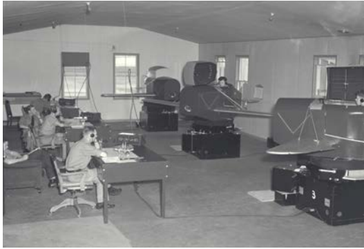
Des élèves-pilotes s'exercent au pilotage sur des simulateurs Link sous le regard de leurs instructeurs.
