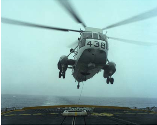
Un Sea King relié au Beartrap sur le pont d'un navire de guerre canadien par un câble.
