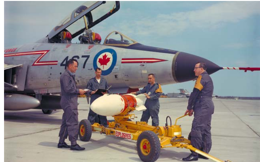
L'équipe au sol de la BFC Chatham inspecte une roquette Genie avant de la charger sur le CF-101 Voodoo. De gauche à droite, on aperçoit : le caporal V. MacFadyen, le caporal J. G. Adams, le caporal R. Leblanc et le caporal J. L. Mather.
