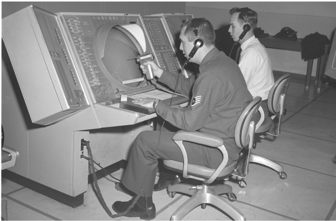
Un sergent de l'USAF emploie un pointeur optique à une console radar au centre de contrôle SAGE à North Bay.
