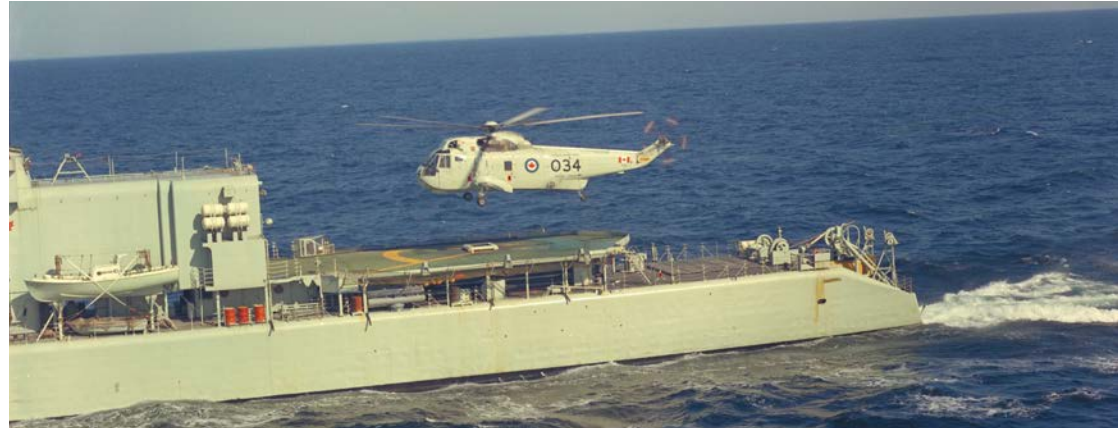
Une vue du NCSM Assiniboine avec un Sea King planant au-dessus du fenestron. Le gros hélicoptère n'a pas beaucoup de marge d'erreur sur le petit pont d'envol du navire, ce qui démontre l'importance du Beartrap, surtout par mauvais temps et par mer agitée.
