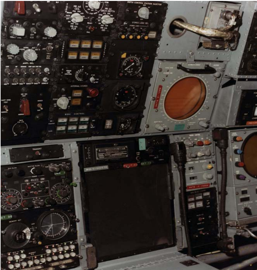
Cette image montre le système TacNav AN/ASN-501 installé dans la console latérale d'un Sea King canadien. L'AN/ASN-501 comprend huit instruments, et ils sont assemblés dans la section inférieure gauche de cette photo.
