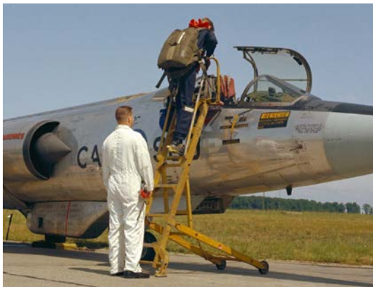
Un pilote de CF-104 se dirige vers le poste de pilotage de son avion alors qu'un membre d'équipage à la BFC Lahr en Allemagne le surveille, vers 1970. L'éperon de siège éjectable situé sur le pied droit du pilote est visible.
