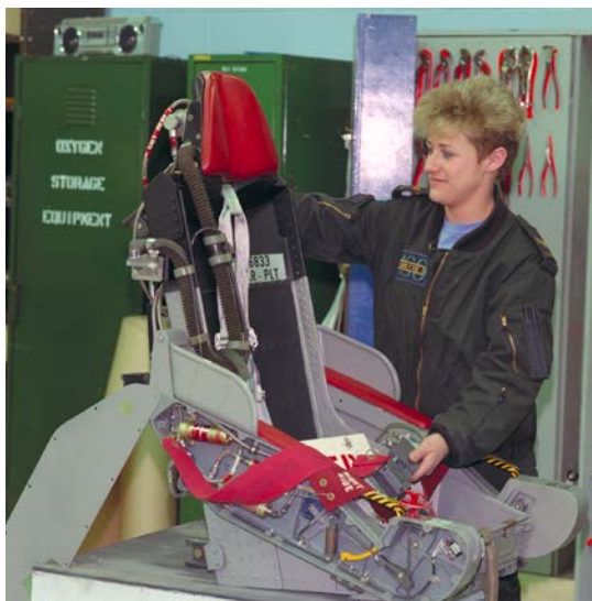
La caporale M. Binette, technicien en systèmes de sécurité, travaille sur le siège d'un CF-5.
