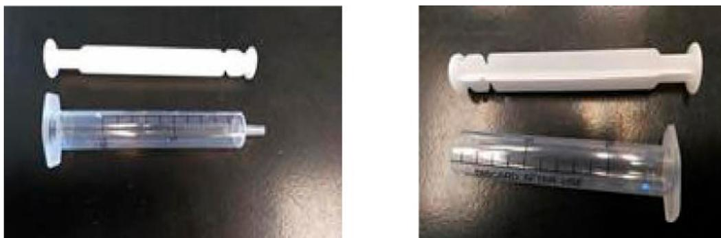
Seringue en plastique modifiée, servant à créer des disques de laine d'argent uniformisés. Pour fabriquer ce dispositif, on coupe l'extrémité de la seringue. En outre, il faut retirer l'extrémité en caoutchouc du piston et la remplacer par un embout en polytétrafluoroéthylène.
