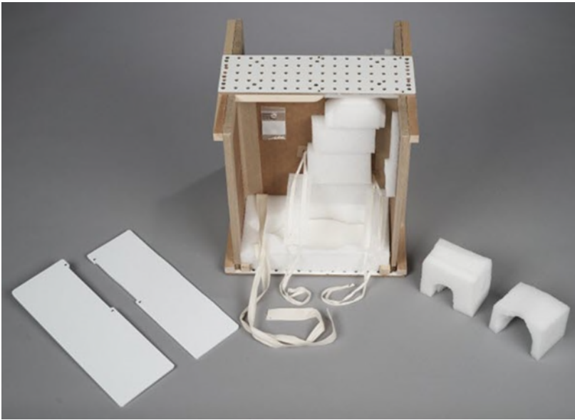
© Gouvernement du Canada, Institut canadien de conservation. 127495-0142 Figure 7a. Éléments nécessaires à la fabrication du système de retenue pour deux sculptures de chiens en céramique séparés par une cloison en carton ondulé triple cannelure.
