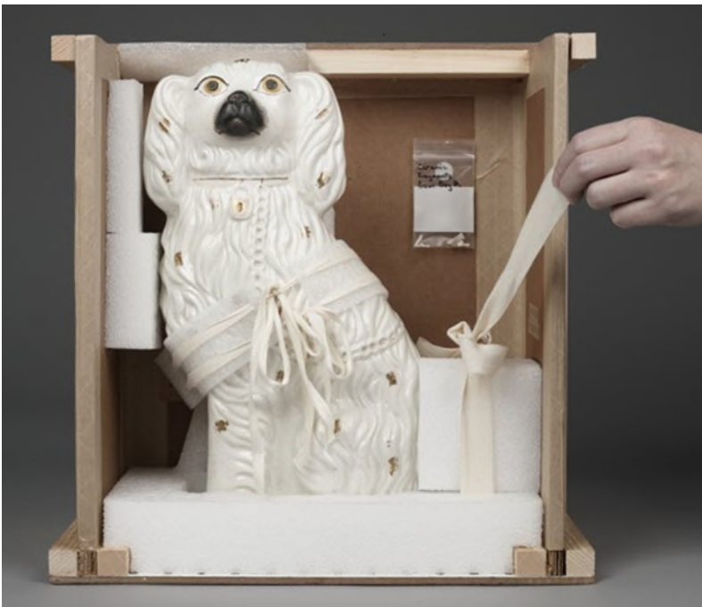
© Gouvernement du Canada, Institut canadien de conservation. 127495-0135 Figure 7b. Dispositif de retenue pour la sculpture de chien d'un côté de la cloison. La mousse blanche est du polyéthylène ferme (comme l'Ethafoam 220).
