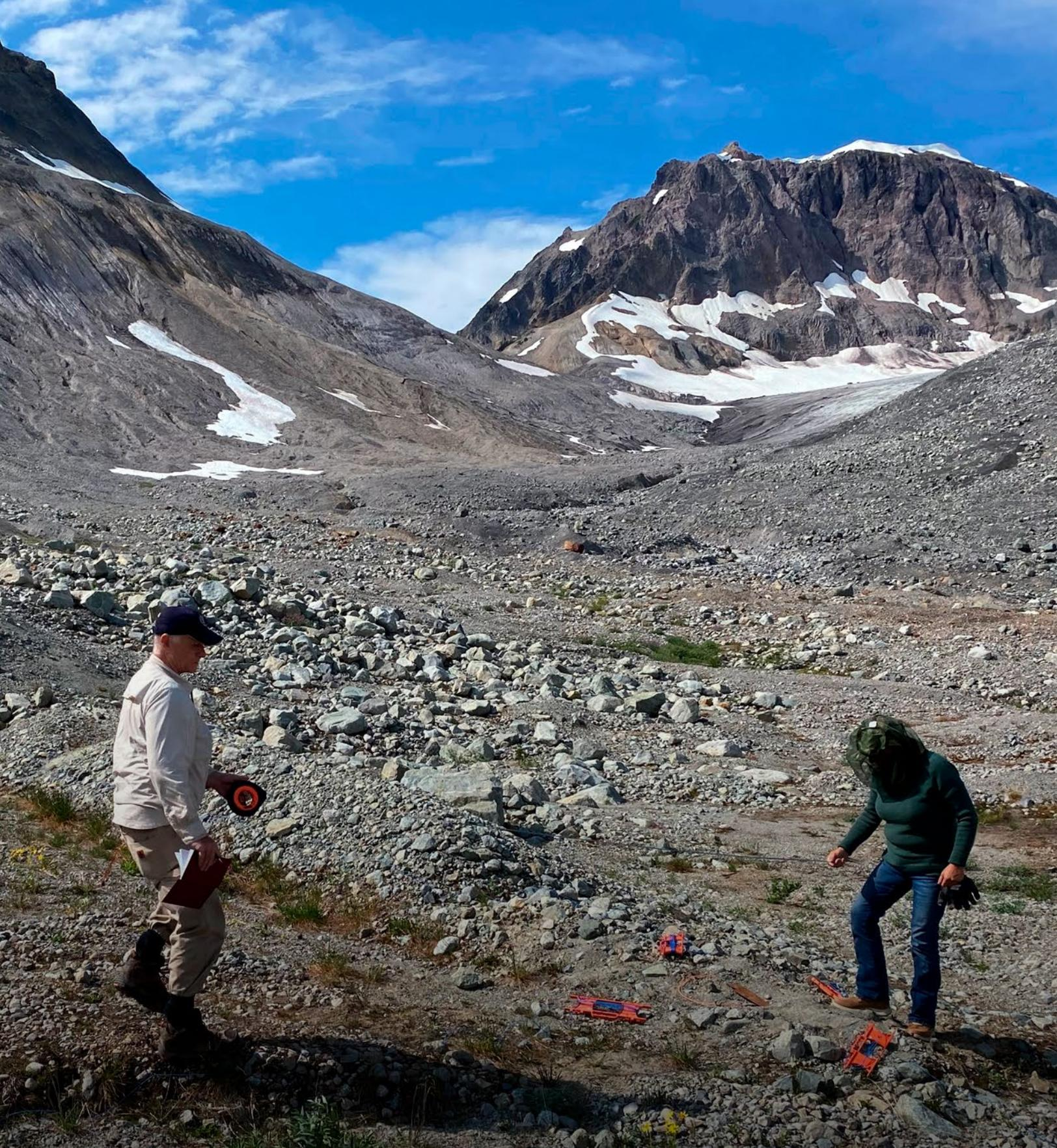
Jim Craven, scientifique de la CGC, installant une station magnétotellurique, utilisée pour visualiser en 3D les réservoirs géothermiques souterrains, sur le flanc du mont Cayley, avec l'aide d'une surveillante environnementale de la Nation des Squamish.
