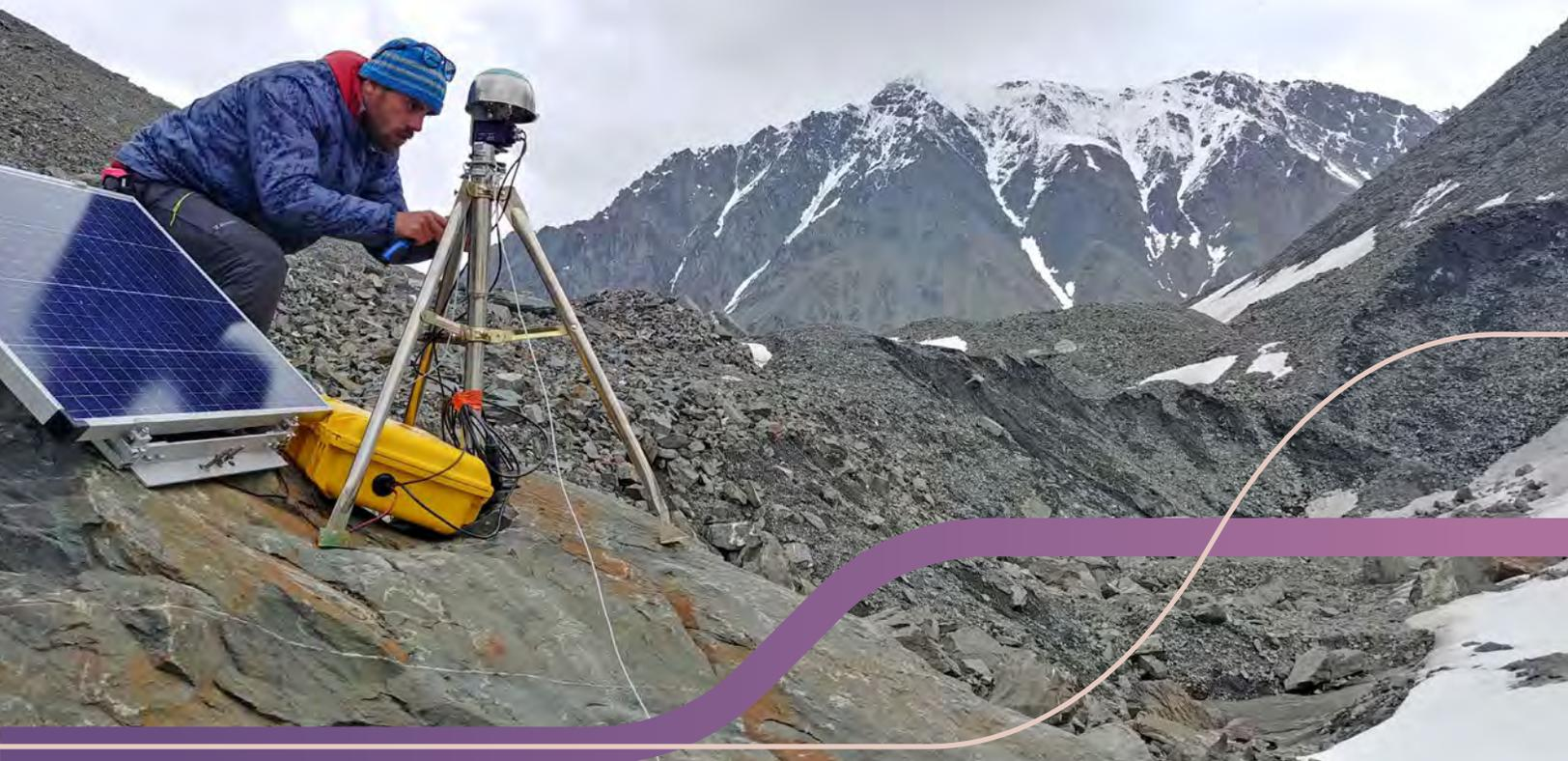
Installation d'une station LiDAR autonome pour surveiller les changements topographiques dans une zone de glace enfouie
