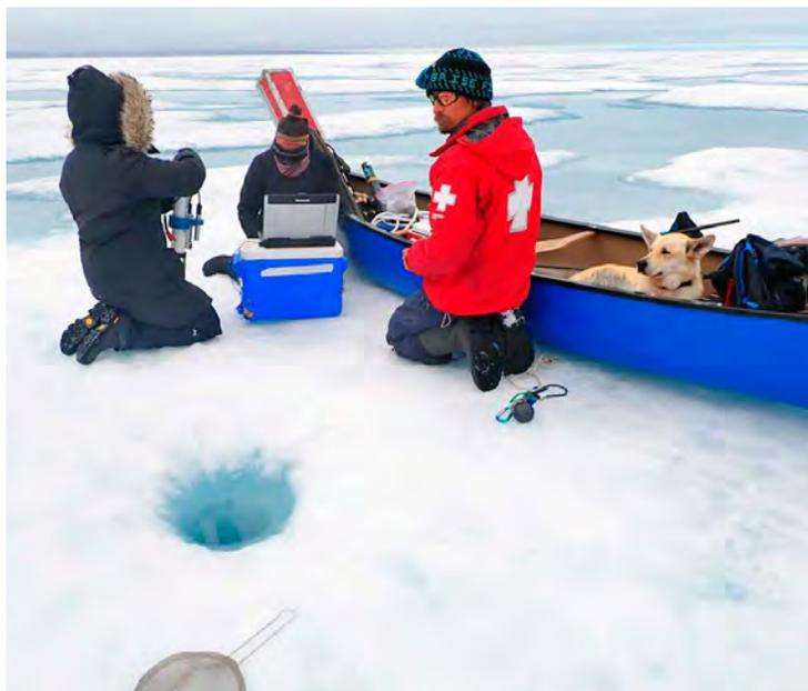
L'équipe déploie un instrument de conductivité, de température et de profondeur pour mesurer la salinité, la température et d'autres caractéristiques de l'eau de mer.
