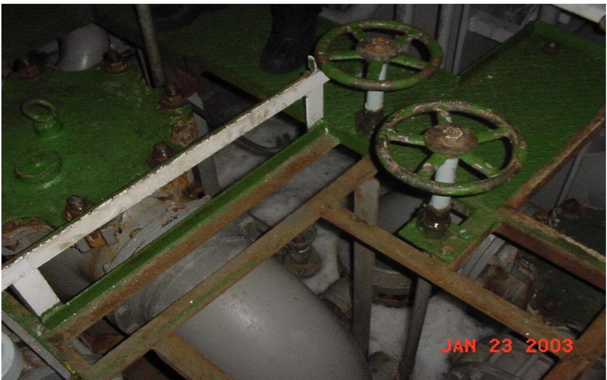
**Figures 3.7B – Accumulation de glace dans les fonds attribuable au nettoyage des crépines**
