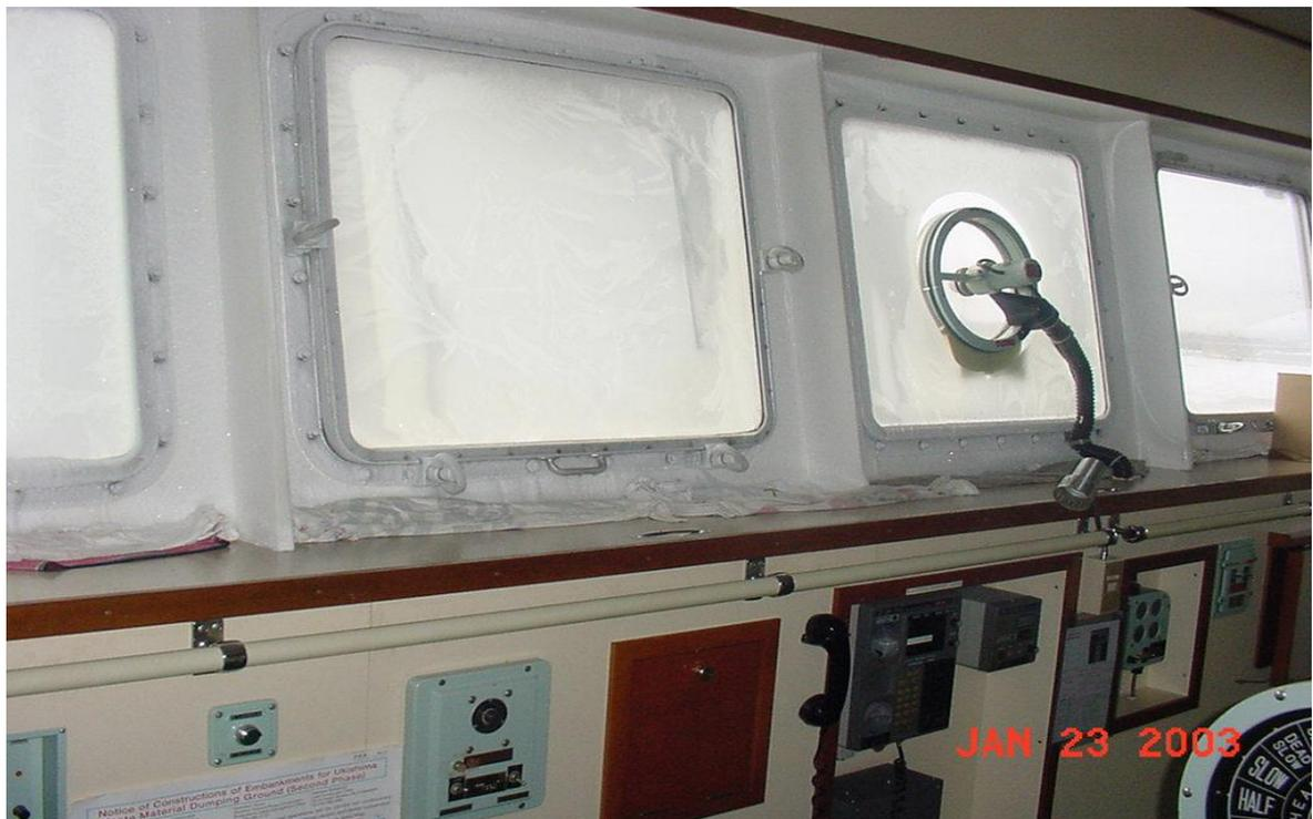
**Figure 9.1B – Chauffage de la timonerie défaillant combiné à un taux d'humidité de l'air excessif**
