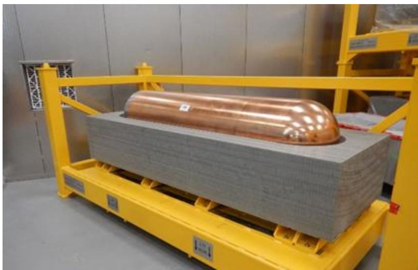
Figure K.10 : Prototype de conteneur de combustible utilisé dans la moitié d'une boîte tampon en bentonite hautement compactée
