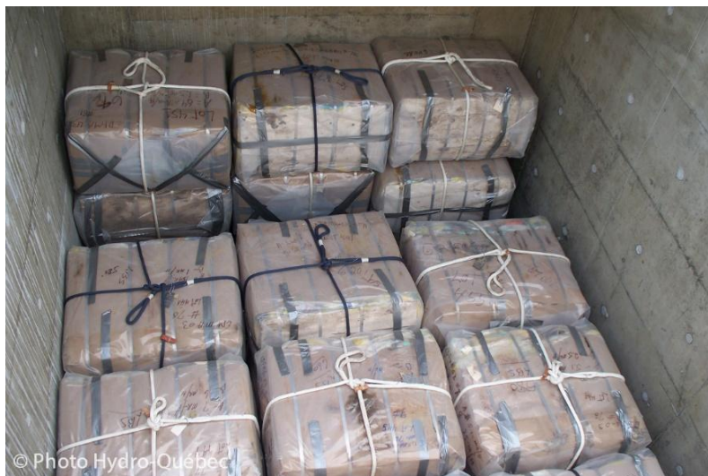
Figure 5.20 : DRFA compactés entreposés à Gentilly-2
