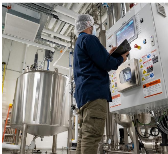
Maintenance et étalonnage du système de purification d'eau; vérification des paramètres et compilation des données.
