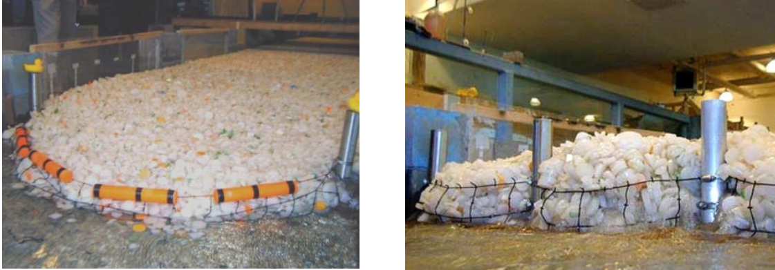
Figure 8 : Deux ouvrages ont été mis à l'essai dans un laboratoire. À gauche : Une estacade fixée à deux piles, avec un filet en dessous. À droite : Des filets entre des piles. Les deux ouvrages sont destinés à retenir les décharges de glace. Tiré de Morse [24], avec l'autorisation de l'éditeur.
