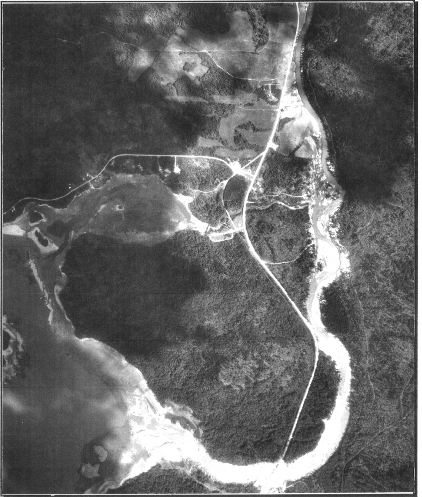
PHOTO #12: Exutoire du lac des Ha! Ha!. Le chenal en bas de la photo correspond au nouveau chenal créé après l'érosion de la digue. (Photo aérienne Q96304 #89, 30 juillet 1996, Échelle 1:15000)
