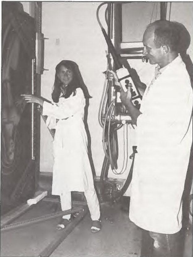
Helen McKay (à gauche) conservatrice à l'Institut canadien de conservation prend une radiographie de La Peinture Mystique en compagnie de Jeremy Powell, technologue, documentation et dossiers scientifiques. La radiographie permet de découvrir les détails des couches inférieures de peinture, une opération qui fait partie de l'examen d'une œuvre à l'Institut canadien de conservation.
