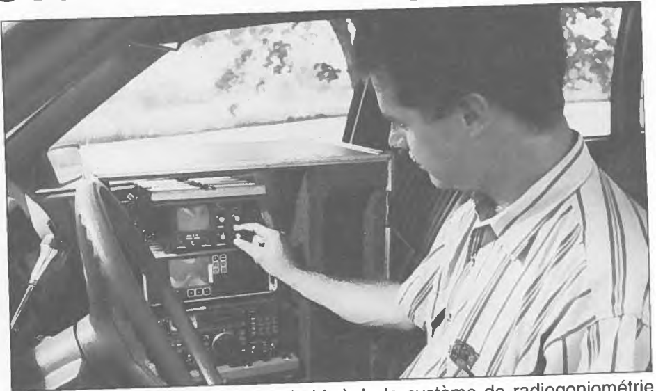
L'inspecteur radio Robert Régimbald règle le système de radiogoniométrie Techcomm, l'un des deux systèmes d'établissement de la direction des signaux que le Ministère évalue.
