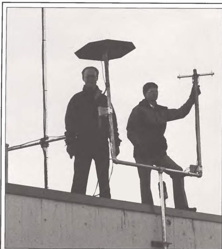
Des essais du système IRMA (matériel intégré de télésurveillance) ont lieu dans les différentes régions du pays. Wayne Janzen et Dave Taschuk vérifient ici les antennes de radiogoniométrie UHF et VHF installées sur le toit du bureau de district d'Edmonton. Voir «IRMA mis à l'essai par les régions et l'administration centrale» page 5.
