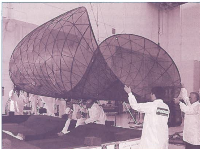
Ces ingénieurs n'ont aucune peine à lever l'antenne « Springback » de 21 kg. Deux de ces antennes, mises au point par la Hughes Space and Communications Company, assureront la communication entre le satellite MSAT et les utilisateurs du système.
