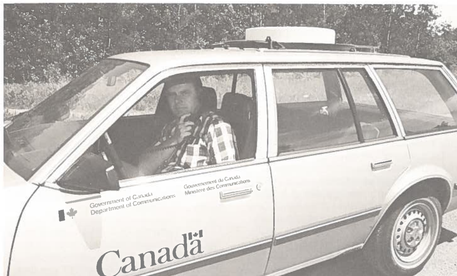
Un prototype de rideau d'antennes en phase, utilisé dans la bande de 800 MHz, est monté sur un véhicule.
