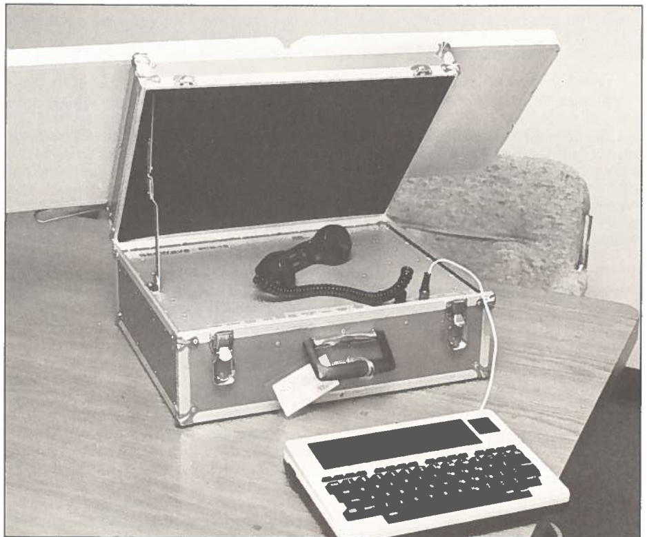
Prototype du terminal de satellites portatif mis au point par la Skywave Electronics Ltd. Cet appareil, qui peut servir à la communication parlée ou à la transmission de données, est présentement en cours d'essais. Ce projet a bénéficié de l'appui du ministère des Communications et du Programme de productivité de l'industrie du matériel de défense (PPIMD) du ministère de l'Expansion industrielle régionale.
