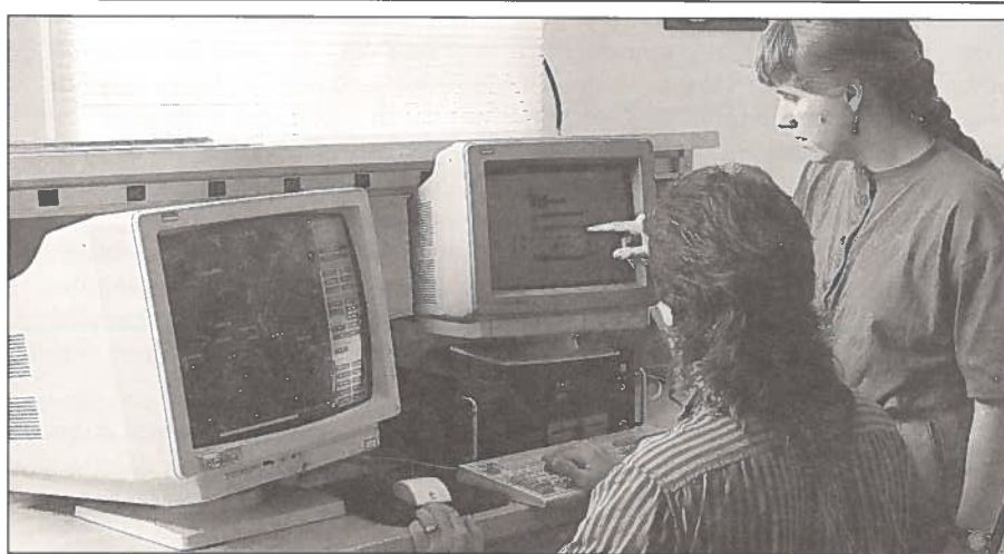
Le technologiste Steve Lamarche et l'ingénieur Trish Michaud du CRC font fonctionner un poste principal de répartition FLAG (système graphique de localisation de véhicule). Le système a été élaboré pour MSAT, afin de permettre aux entreprises de transport de suivre leurs véhicules. Le poste qui figure sur la photographie sert à donner des démonstrations et à former les utilisateurs éventuels, au Centre de recherches sur les communications.
