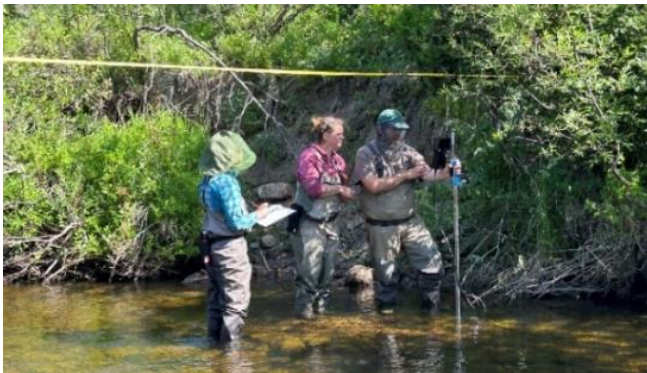
Figure 1. Transect de débit effectué lors de l'installation de l'enregistreur de niveau, le 17 juillet 2024.
