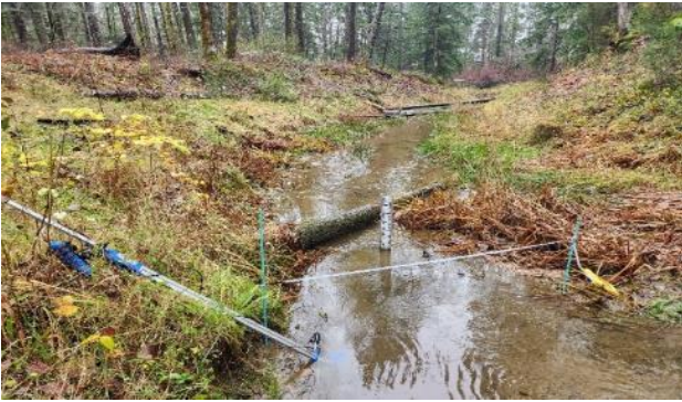
Figure 1 : Chenal secondaire Arthur Mayse, rivière Oyster. Site de surveillance en amont (niveau d'eau, débit et température).
