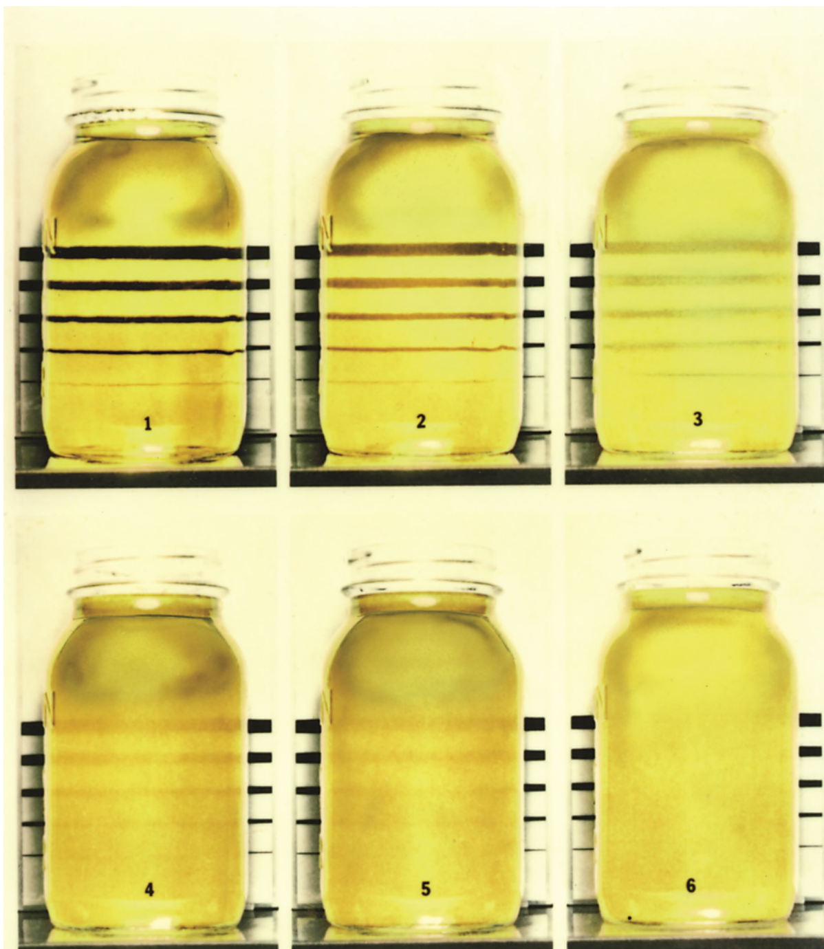
Figure 2 – Évaluation de la turbidité visuelle – Carte normalisée d'évaluation de la turbidité
