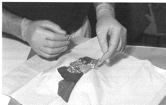
Figure 9. (À gauche) Mélange des deux composants de la pâte époxy; la surface de la céramique qui doit être moulée est protégée avec du papier d'aluminium. (À droite) La pâte époxy est appliquée à la céramique protégée, façonnée, puis laissée à durcir. Photos : Jean Blanchet, Centre de conservation du Québec.
