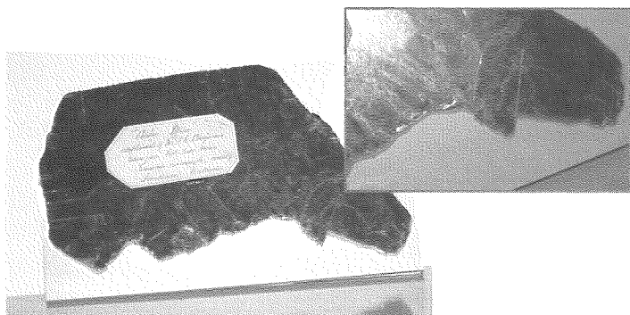
Figure 1. Cette délicate feuille de mica devait être soutenue sur une grande surface, pour répartir son poids, sinon elle risquait de s'effriter. Le support consiste en une base de contreplaqué qui épouse la forme du mica, matelassée avec de la mousse de polyéthylène. Photos : Institut canadien de conservation.
