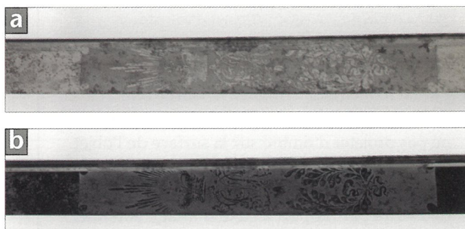
Figure 45. Ces photographies d'une épée gravée ont été prises avec un appareil photo dont l'objectif a été inséré dans un trou découpé dans un carton. a) L'image, prise en utilisant un carton blanc, révèle la corrosion et certains détails de la gravure. b) L'image, prise en utilisant un carton noir, révèle plus de détails de la gravure. Épée (artisan/fabricant inconnu, 1822), Niagara Historical Society & Museum, numéro de catalogue 992.156.01.
