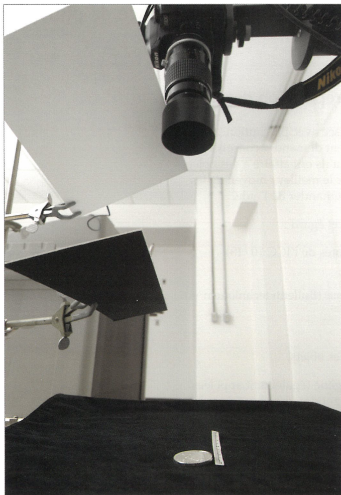
Figure 75. Exemple de disposition des cartons réflecteurs au-dessus d'une pièce de monnaie.
