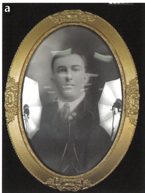
Figure 35. a) Portrait encadré sous vitre convexe, photographié sous éclairage normal, présentant des reflets indésirables. b) Le même portrait, photographié avec deux lampes à un angle très faible et en masquant toutes les réflexions autour de la mise en place. Dans ce cas, les reflets indésirables ont été éliminés. Portrait appartenant à une collection privée.
