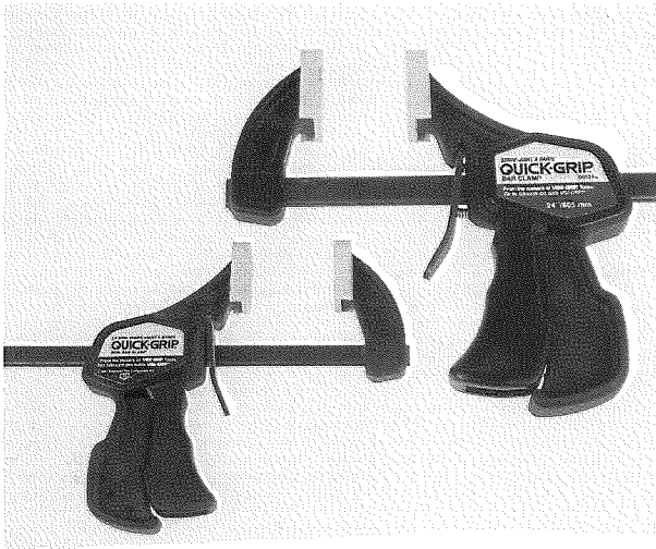
Figure 22. Bien des serre-joints comportent une gâchette. Certains des plus communs sont présentés ici.
