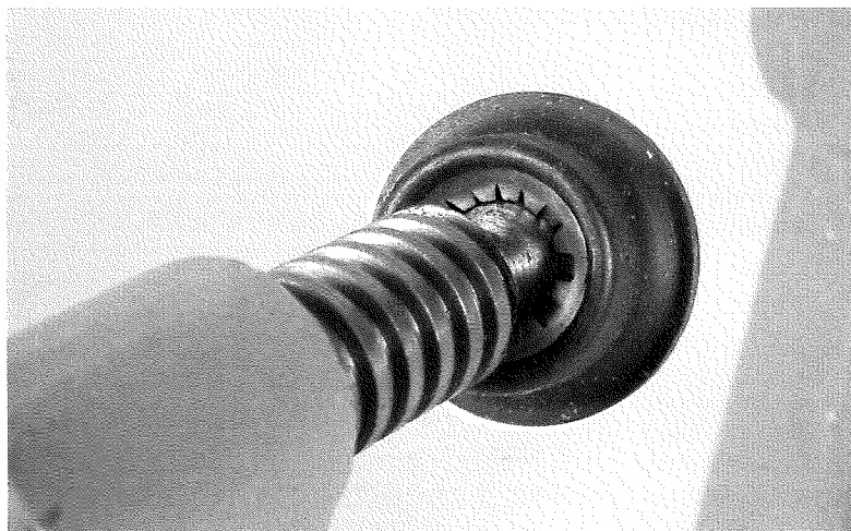
Figure 12. Gros plan de la rotule d'un serre-joint en C qui convertit la rotation de la tige filetée en mouvement linéaire. Il est important de bien graisser les rotules.
