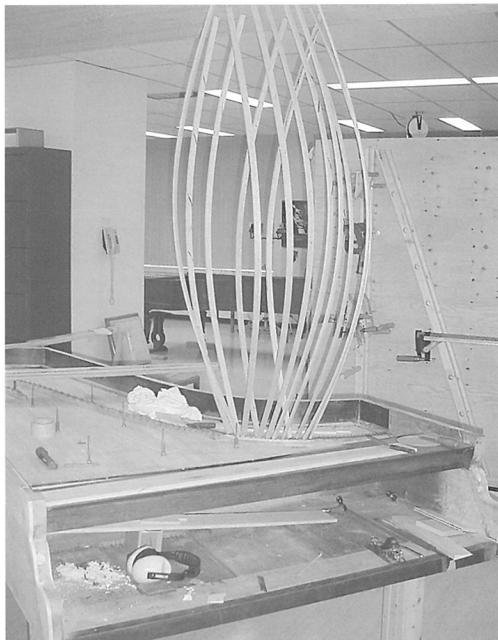
Figure 41. On exploite l'élasticité de goujons de bois pour faire pression sur un instrument à clavier le temps que l'adhésif sèche. La feuille de contreplaqué du dessus est fermement fixée aux poutres du plafond. (Photo : Cantos Music Foundation)
