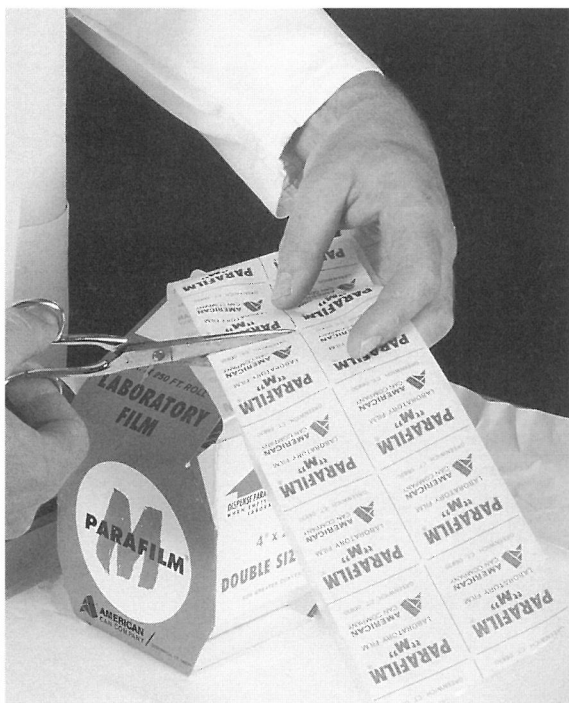
Figure 45. Un rouleau de Parafilm avec son papier intercalaire (qui empêche la pellicule de coller sur elle-même lorsque enroulée). Le Parafilm est utile pour exercer une pression très légère.
