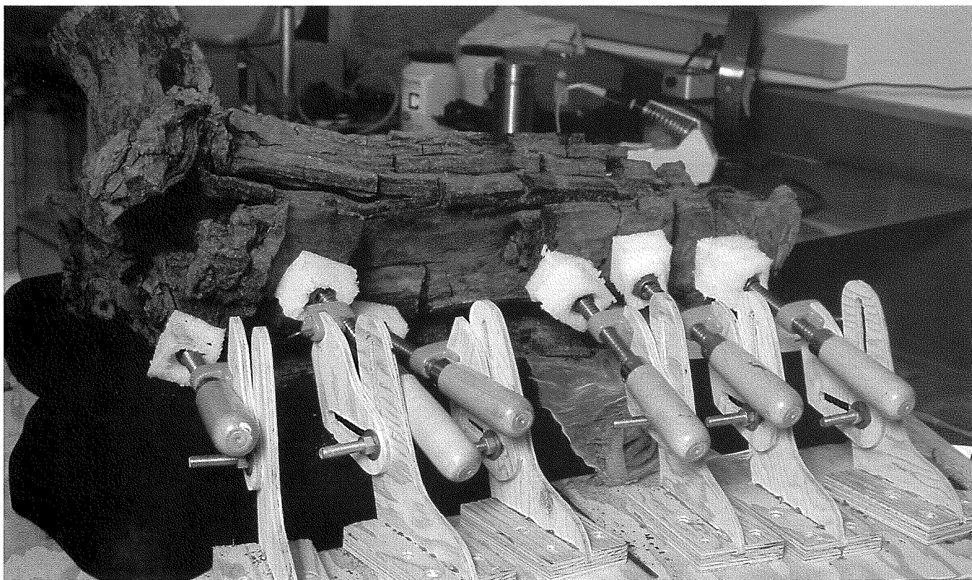
Figure 13. Les morceaux détachés d'un rondin fossilisé provenant de l'île Axel-Heiberg, dans l'Extrême-Arctique canadien, ont été remis en place en adaptant des têtes de serre-joints afin de faire pression à différents angles.
