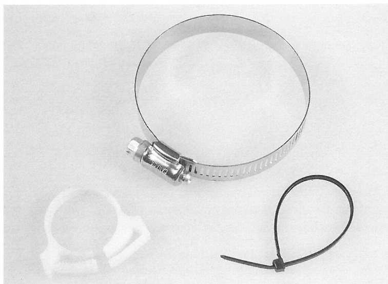
Figure 58. Les colliers de serrage et étrangleurs pour les automobiles ou les conduits électriques ont maintes utilisations.
