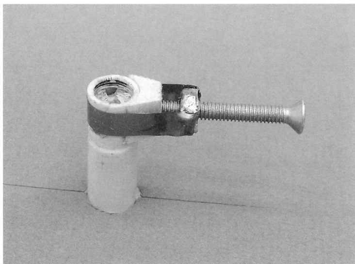
Figure 53. Un petit collier de serrage fait de fer blanc complété par un écrou et un boulon. L'extrémité du boulon porte sur un bloc de bois façonné.
