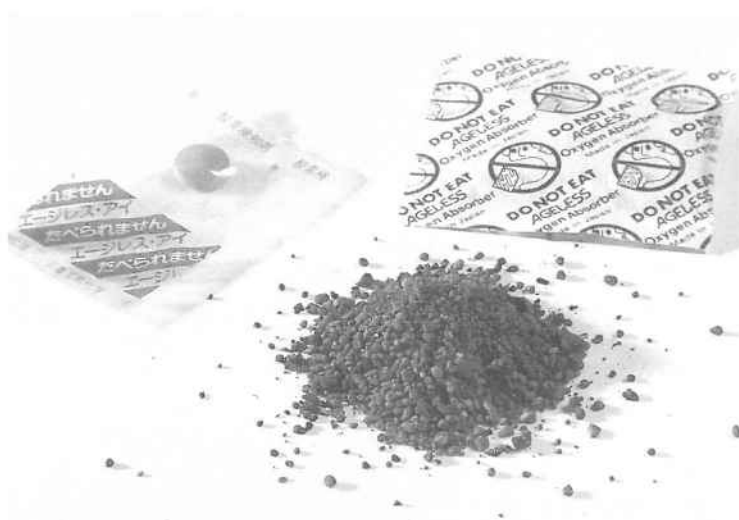
Figure 43. Les sachets Ageless (sorbant d'oxygène) contiennent une fine poudre de fer couverte de sel de mer et d'une zéolite naturelle imprégnée de chlorure de sodium. La petite capsule scellée dans le sac de plastique transparent (à g.) est un dosimètre à oxygène.
