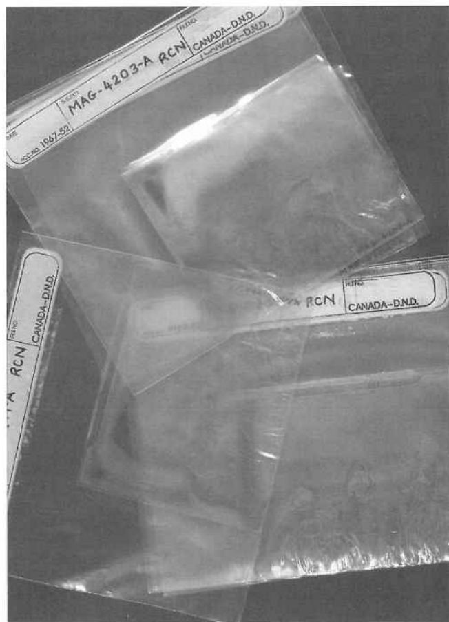
Figure 12. Feuilles de nitrate de cellulose dont la détérioration est avancée. La couleur des feuilles a viré à un brun jaunâtre. Voir la planche en couleurs p. 97.
