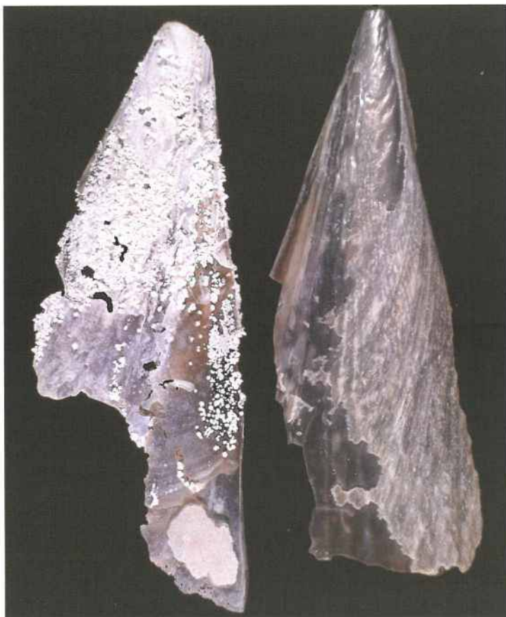
Figure 25. Efflorescence sur des coquillages. Le coquillage de gauche a été exposé à des vapeurs d'acide acétique et à une forte HR. L'échantillon de contrôle est à droite. Ce type de détérioration est parfois dit « maladie de Byne » en l'honneur de M. Loftus St. George Byne qui a été le premier à en fournir une description en 1899 (Byne, 1899). L'efflorescence ne se produit généralement pas moyennant le contrôle de l'HR, la propreté de l'échantillon et l'absence de matériaux émissifs très acides. (Voir page 29 pour plus d'information.)
