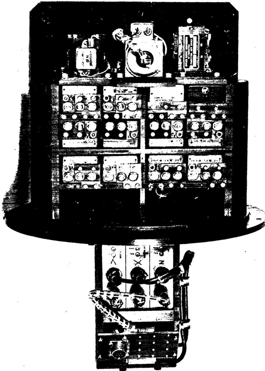
ASSEMBLED TELEMETRY PACKAGE
