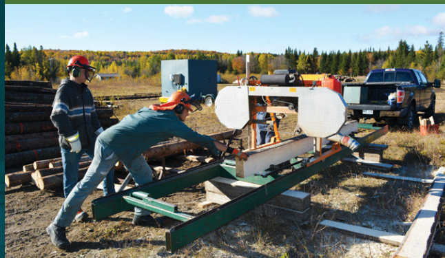
Figure 3. Transformation des billes en bois d'œuvre à l'aide d'une scierie mobile (photo : I. Duchesne).
