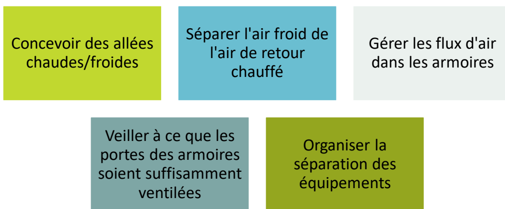
Figure 12 : Bonnes pratiques pour le refroidissement des serveurs
