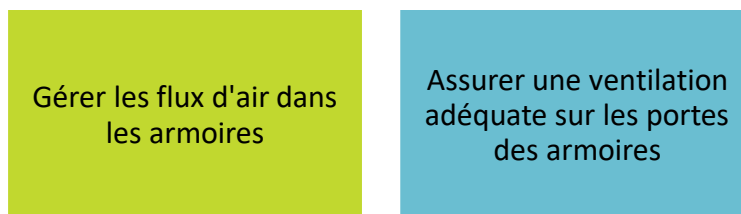
Figure 23 : Bonnes pratiques de refroidissement – Utilisateurs de colocation
