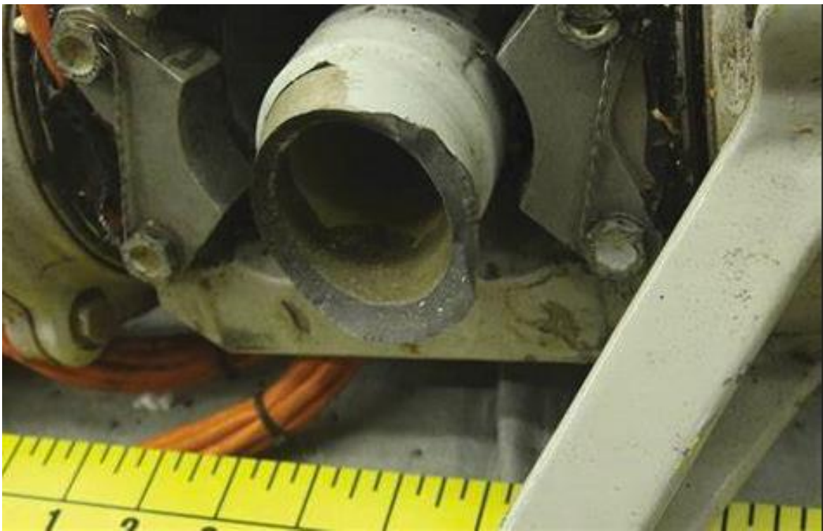
La figure 1 « NTSB » montre le mode de défaillance du mât juste en dessous de l'endroit où la butée statique toucherait. Le cognement du mât s'est produit avec ce rotor de Bell 206 provenant de l'hélicoptère du rapport WPR19FA109 du NTSB
