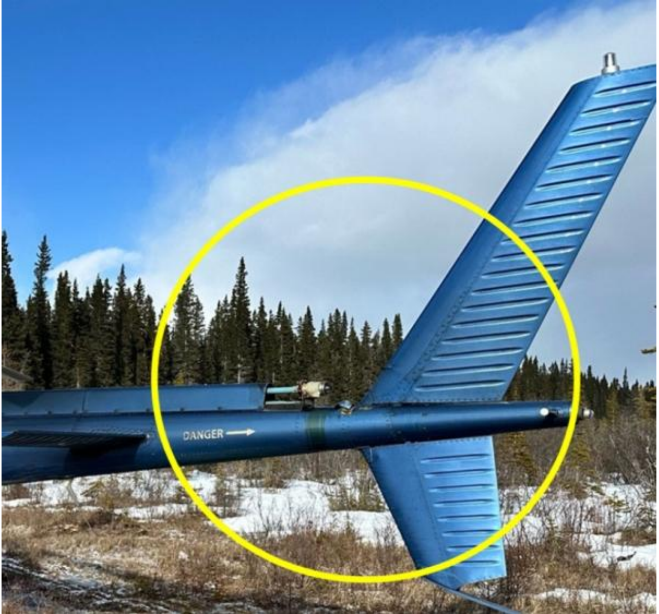
Figure 4 : Marques sur la poutre de queue (mot « DANGER » et flèche) de l'hélicoptère à l'étude et rayon approximatif de l'arc du rotor de queue
