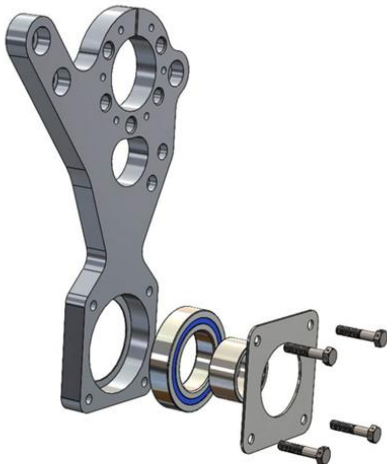
Support redessiné comprenant un roulement
