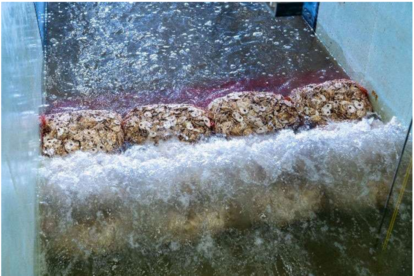
Barrière d'urgence contre les inondations naturelle composée de sacs biodégradables remplis de coquilles d'huîtres.
