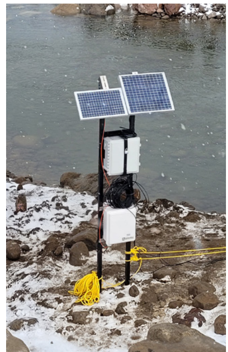
Système employé pour saisir des données sur la qualité de l'eau et le débit de la rivière Duval, à Pangnirtung.
