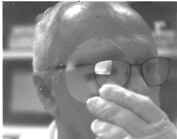
Figure 3. Image visible comparée à l'image SWIR mettant en évidence la transparence d'une tranche de silicium.
