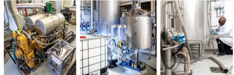
Équipement de conversion hydrothermale d'Ottawa et équipement des installations de bioprospection minière et de biotransformation de Royalmount
