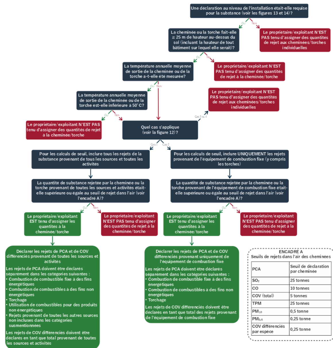
Figure 16. Déclaration pour des cheminées et des torches individuelles – Installations des cas 1 et 2
