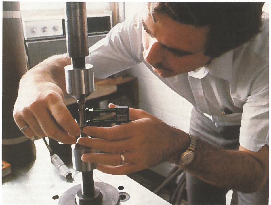
Technicien faisant un essai de tension sur un métal en vue de la certification.
