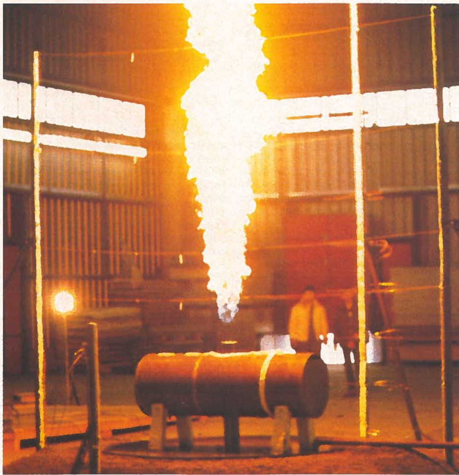
Simulation de dégazage du réservoir au propane d'une automobile.
