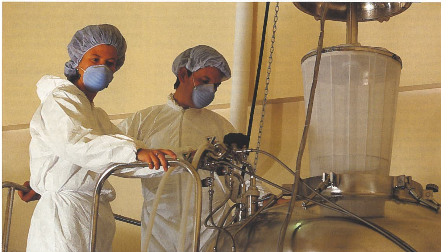
Fermenteur servant à la fabrication de vaccins.
