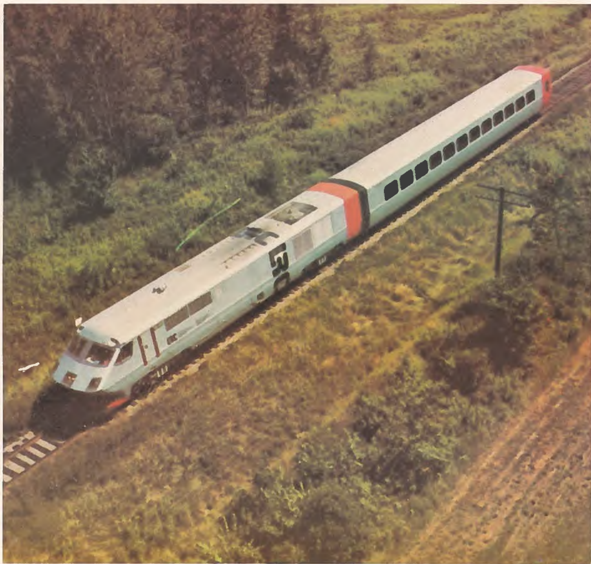
Le nouveau train de voyageurs interurbain LRC (léger, rapide, confortable) avec locomotive diesel électrique et voiture de 84 voyageurs a récemment été mis à l'essai entre Montréal et Ottawa. Le LRC peut maintenir une vitesse moyenne de 100 mi/h (161 km/h) et atteint une vitesse de pointe de 120 mi/h (193.2 km/h).
