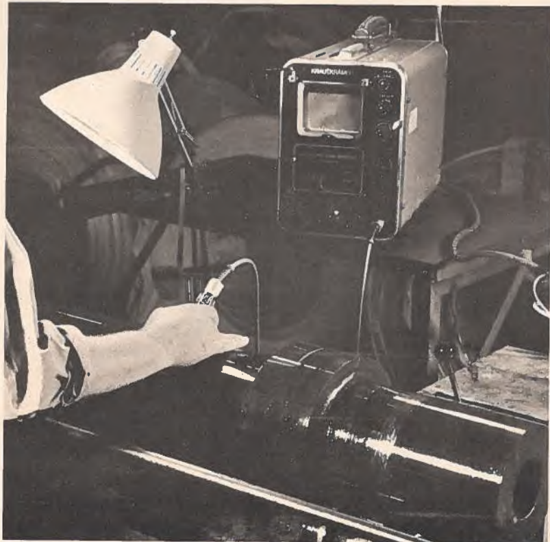
À cause du rôle qu'elle joue dans le fonctionnement des réacteurs nucléaires, chaque culasse en acier coulé doit subir 10 contrôles rigoureux. Ici le test aux ultrasons.
