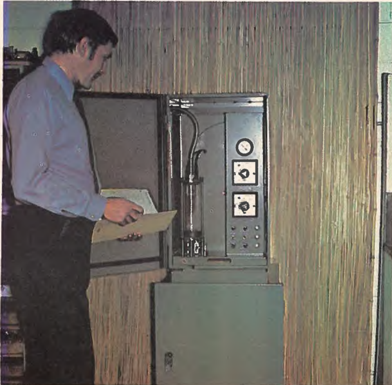
Modèle d'échantillonneur des eaux d'égouts de la série B/ST-VS de la société Sirco Controls, prêt à entrer en service dans une usine municipale de traitement des eaux d'égouts.
