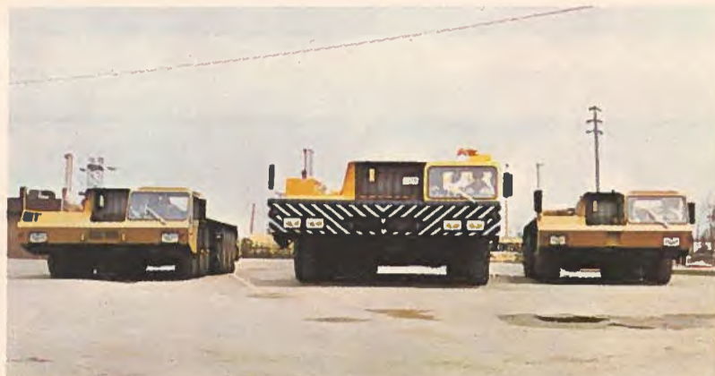
Trois châssis autoporteurs de grues de Consolidated Dynamics. De gauche à droite, modèle 12615 (d'une capacité totale de levage de 150 tonnes), le 12625 (250 tonnes), et le 10665 (65 tonnes).
