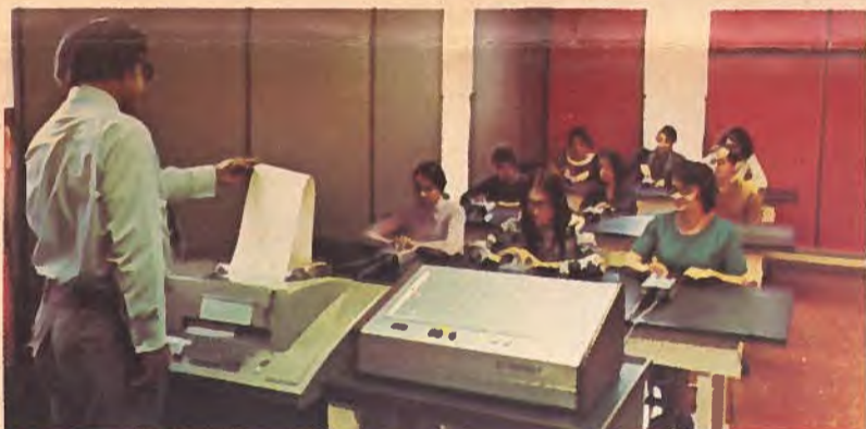
De conception et réalisation canadiennes, cet instrument pédagogique électronique permet de voir sur-le-champ la réponse des élèves. Il peut être raccordé à un télécriteur et à un ordinateur pour obtenir des dossiers permanents. Cet équipement a été mis au point et fabriqué par E.D.A. Electronics Limited.
