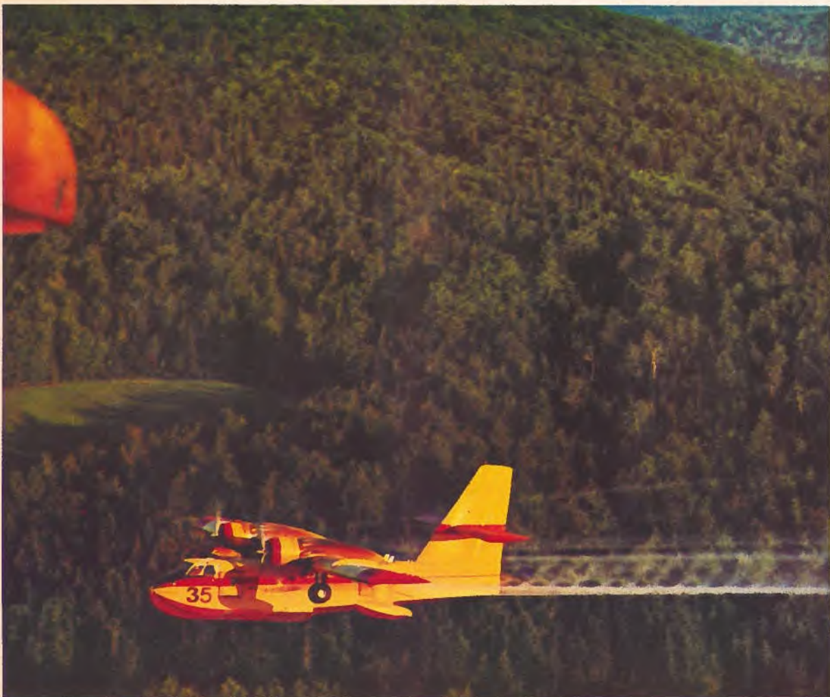
L'avion amphibie CL-215 utilisé pour pulvériser de l'insecticide sur des forêts de sapins et préserver ainsi les bourgeons d'épinette contre l'invasion des vers destructeurs. C'est aussi un avion citerne pour combattre les incendies de forêt et un avion qui sert à des opérations de topographie aérienne, de surveillance, de recherche et de sauvetage.
