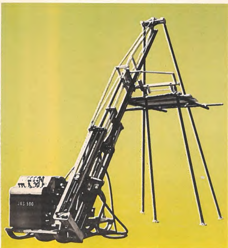
Le carottier hydraulique au diamant JKS 500, pour l'exploration minière souterraine et de surface, l'étude des fondations, l'exploration sismique et le forage à petit diamètre. Il peut forer sous tous les angles, de la verticale à l'horizontale.
