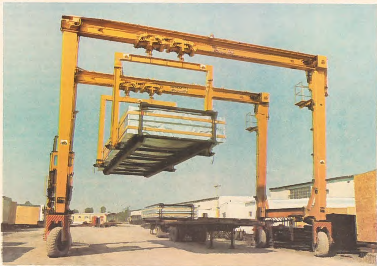
Une salle de classe mobile, réduite pour l'expédition à une épaisseur de 30 pouces (762 mm) seulement. En réalité, elle a 9 pieds (2.7 m) de hauteur, 12 pieds (3.6 m) et 37 pieds (11.2 m) de longueur après son assemblage. Les unités sont manufacturées par Atco (Québec) Limited et exportées sur les marchés internationaux.
