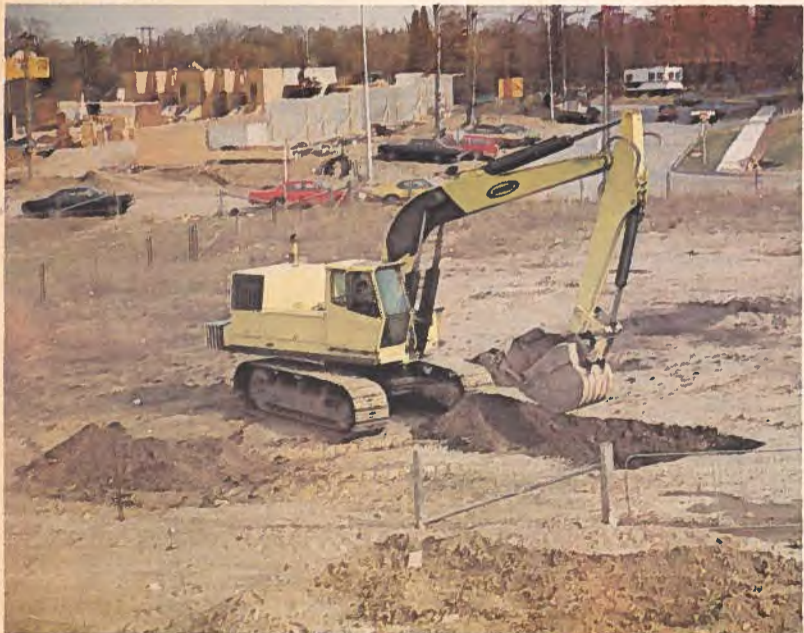
La 6000TT est la dernière de toute une gamme de rétrocaveuses à commandes hydrauliques fabriquées par la Hy-Hoe Corporation Limited, de Arnprior (Ontario). La 6000TT a un mouvement continu et précis à 4.0 tr/mn, pèse environ 81 000 livres (36 774 kg) et a une portée horizontale maximale de 37 pieds 5 pouces (11.3 m).
