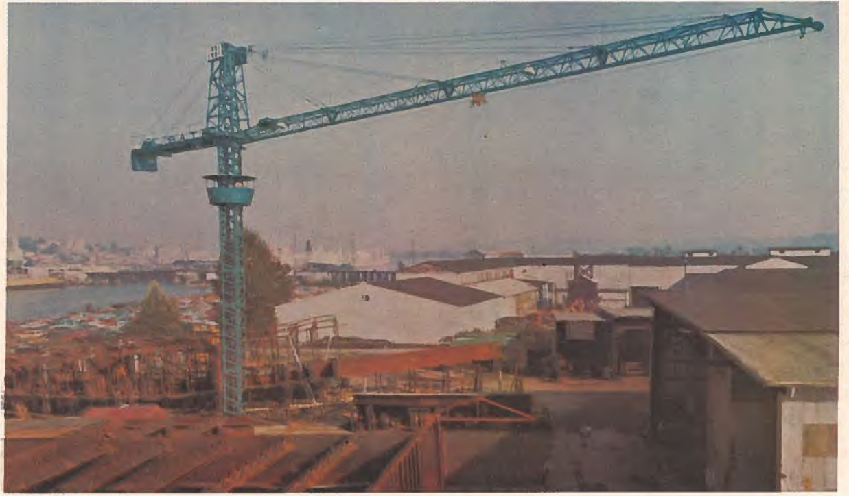
Heede International Ltd, l'un des fabricants originaux de grues de chargement en Amérique du Nord, construit des grues dont la capacité et les dimensions varient: elles peuvent avoir une volée qui va de 100 pieds (30.5 m) à 205 pieds (62.5 m) et une capacité qui va de 6 000 livres (2 724 kg) à 12 000 livres (5 448 kg).
