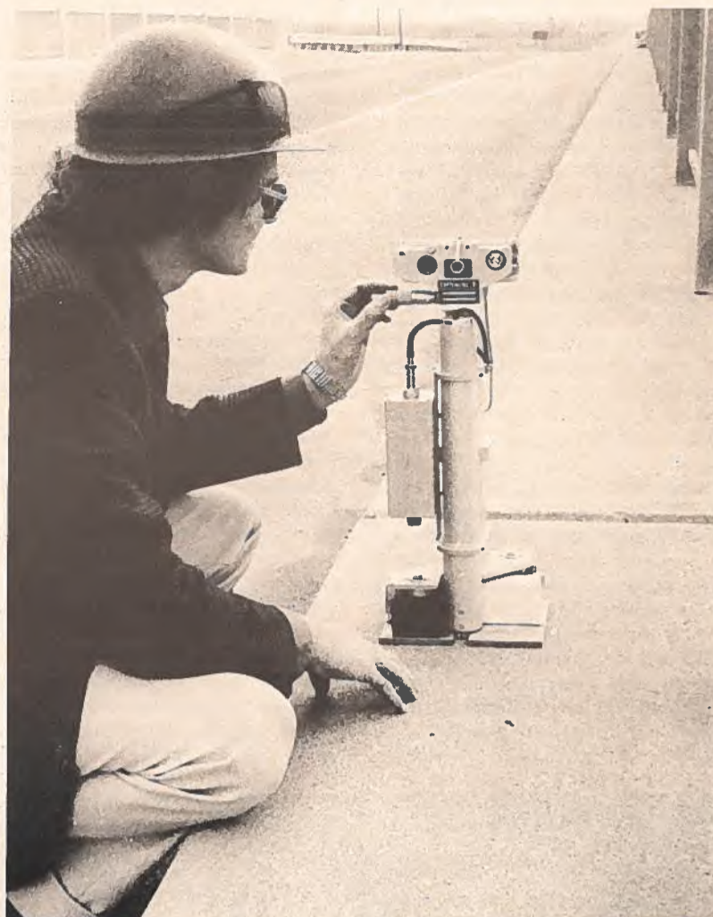
L'extensiomètre, utilisé pour mesurer les dilatations qui se produisent dans les ponts, les tunnels et les bâtiments en béton, peut être incorporé à la structure; il ne perdra jamais sa précision.
