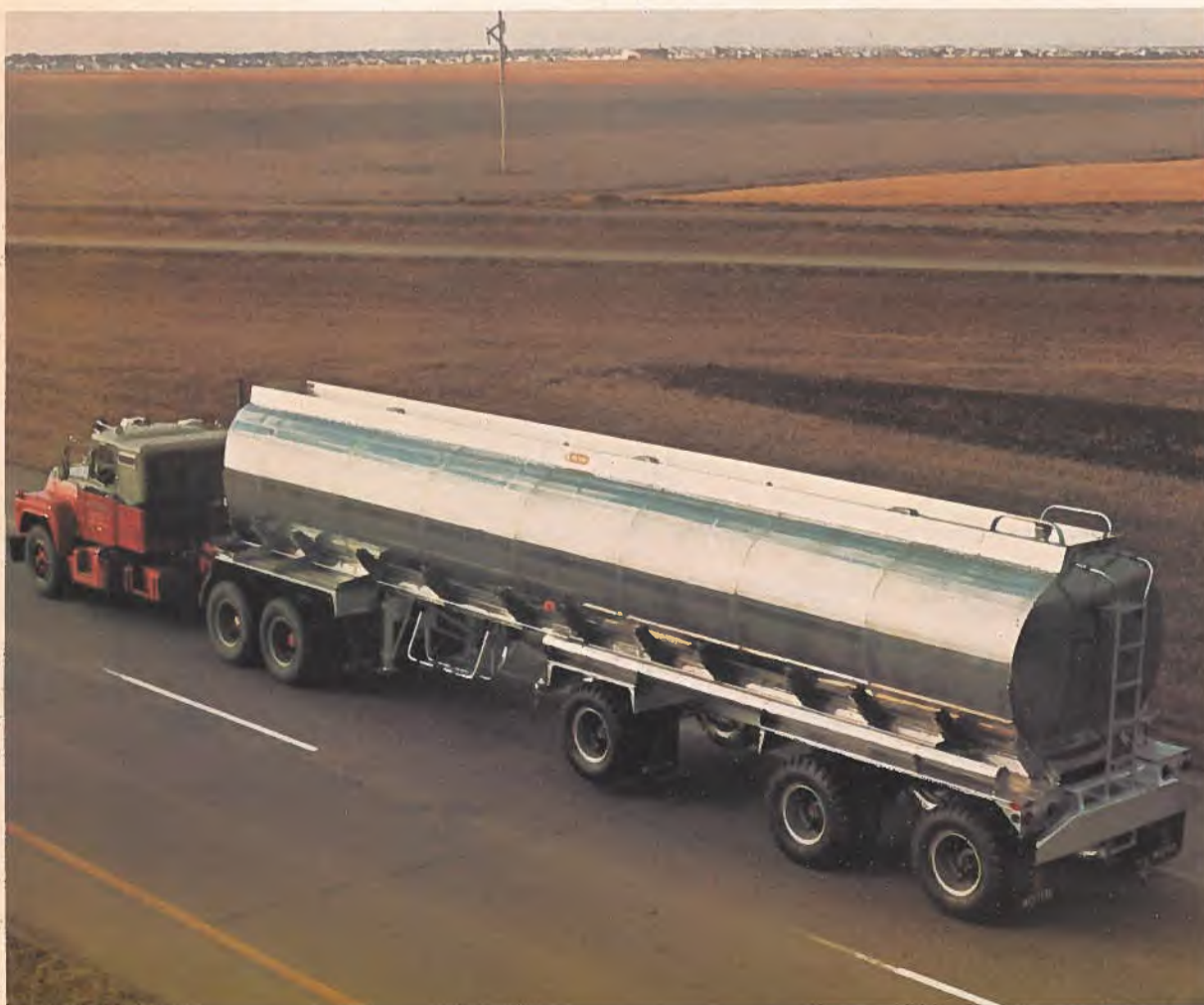
Conçue et fabriquée par Westank Industries, cette unité à trois compartiments en aluminium, pour le transport de produits liquides en vrac, a une capacité de 10 500 gal (47 775 l). Elle est équipée de nombreux dispositifs de sécurité, dont des trous d'homme à pression à vide, cloisons étanches embouties hydrauliquement et bridées, soupape de sécurité intérieure et pare-chocs très résistants. Entreprise d'avant-garde, Westank peut assurer la conception et la construction sur commande de tout matériel servant au transport en vrac.
