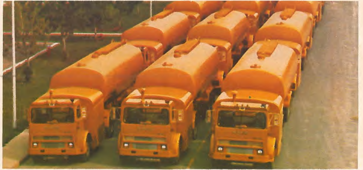
Le premier lot d'une commande de 40 camions-citernes pour le ravitaillement des avions a été accompagné par la police jusqu'à Montréal, d'où il sera expédié en Iran. Fabriquées par EGW Limited, ces unités mesurent 53 pi (16.1 m) de longueur et ont une capacité de 40 000 l. Code 7-1
