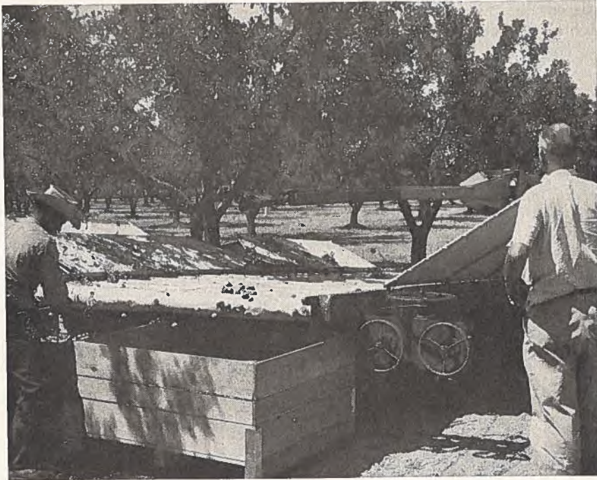
Récolte des prunes dans un verger de Californie au moyen d'un "secoueur" mécanique portatif. La grosse pince à l'arrière-plan secoue l'arbre et les prunes tombent dans des récipients en bois.
