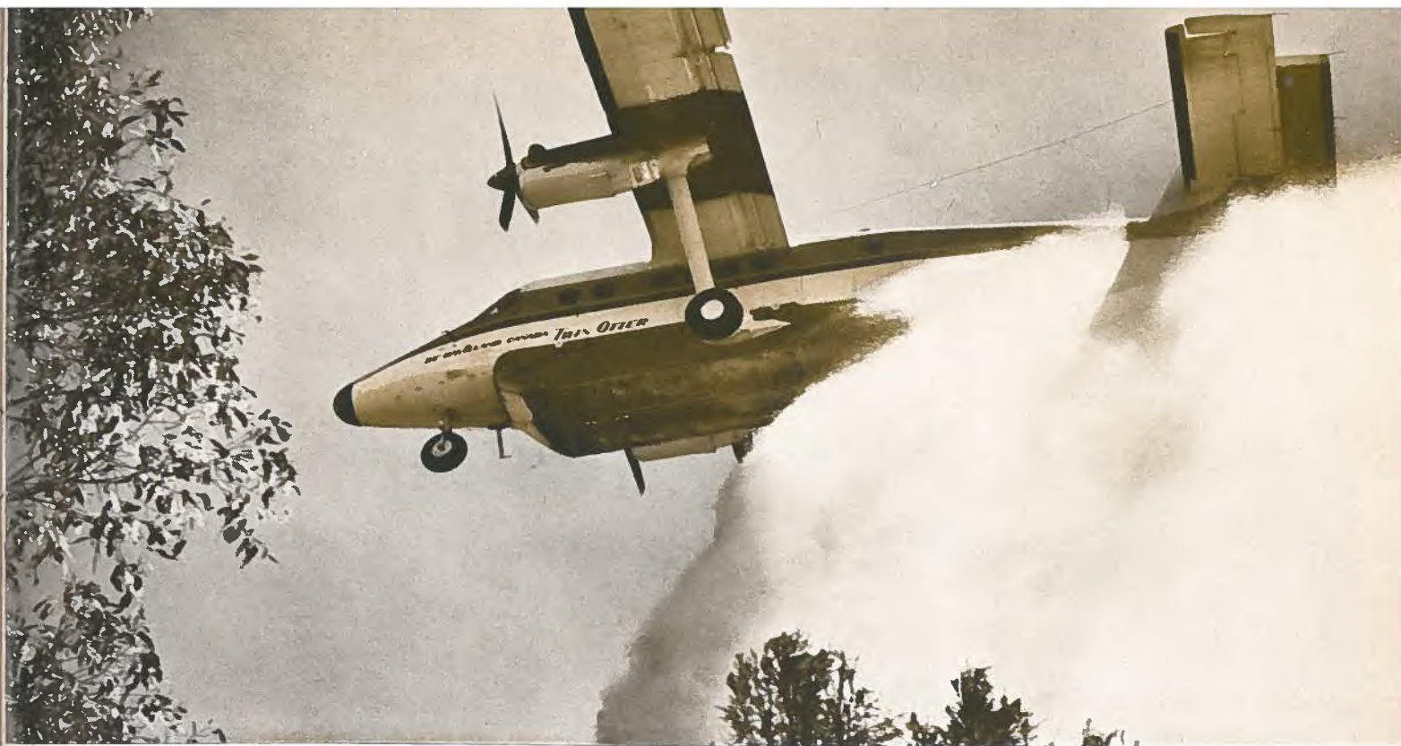
On voit ci-dessus l'avion muni d'un réservoir à membrane installé sur le dessous de l'appareil. À côté, le pilote manipule les couteaux qui servent à percer le réservoir et à vaporiser son contenu, à l'aide d'un dispositif réglable. Les hauts fonctionnaires australiens sont convaincus que ce dispositif de conception canadienne pourrait aider à combattre les feux d'eucalyptus.
