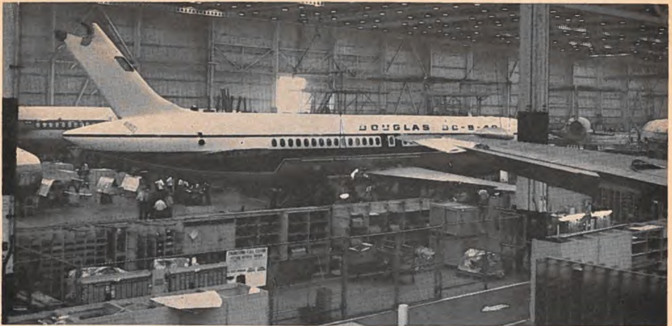
La chaîne d'assemblage du DC9 de l'immense usine Douglas Aircraft à Los Angeles. Douglas s'approvisionne auprès de plus de 22,000 fournisseurs, dont des sociétés canadiennes. Les ailes de l'avion que l'on voit sur cette photo ont été entièrement fabriquées dans une usine canadienne.
