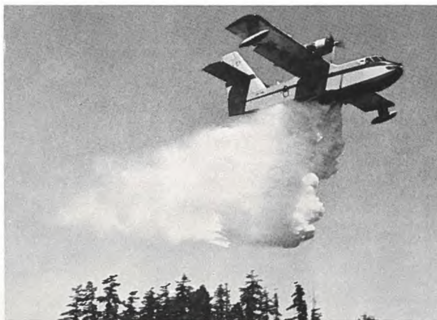
C'est ainsi que procède le Canadair CL-215 pour éteindre un feu de forêt en le bombardant littéralement avec de l'eau. Lorsque l'eau est entièrement déversée, l'avion descend sur un lac ou une rivière et refait le plein. La France a commandé dix de ces appareils. Nous avons là un exemple qui démontre jusqu'à quel point l'innovation technologique aide à promouvoir le commerce extérieur du Canada.
