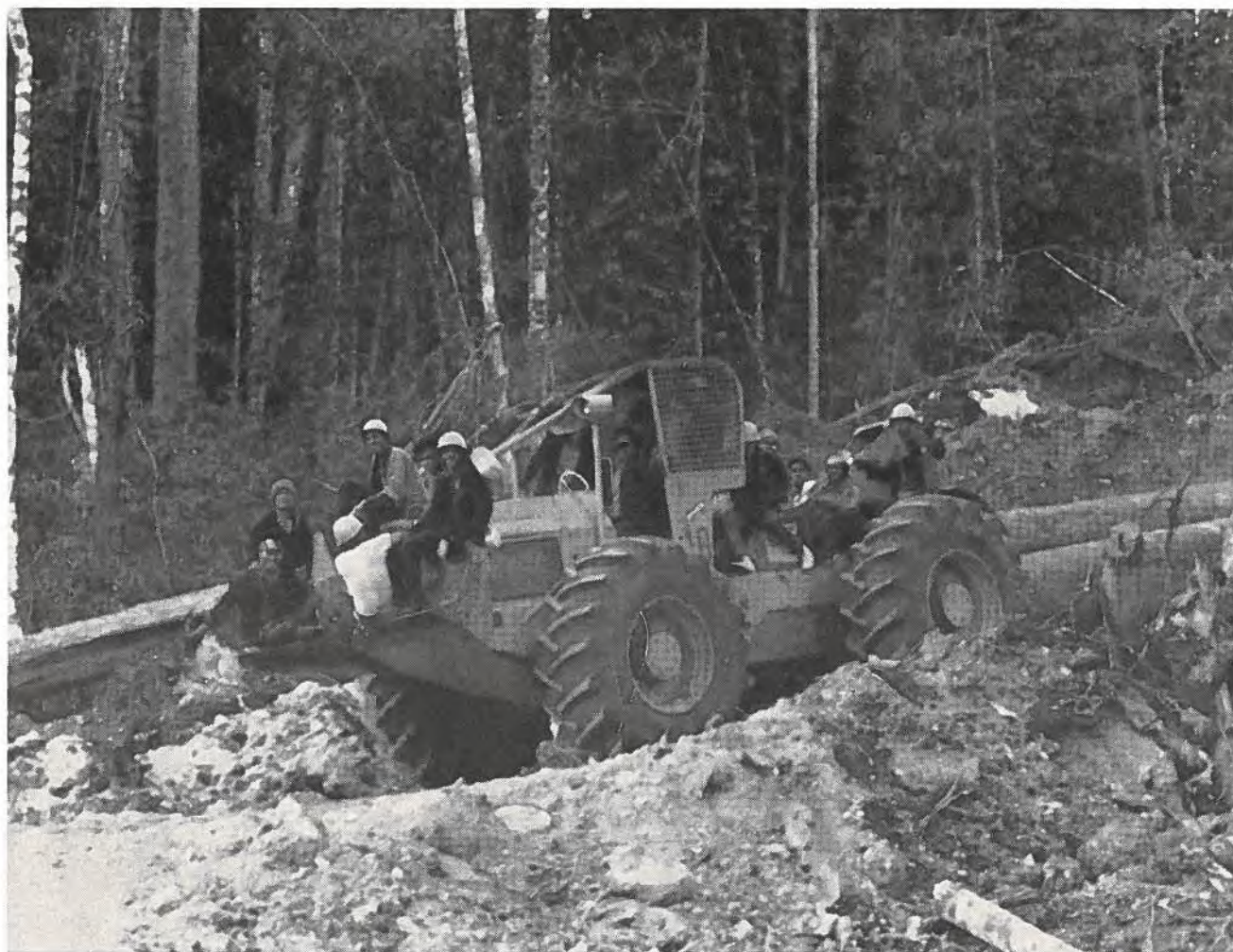
C'est le moment de la pause à un chantier forestier en Indonésie. Les travailleurs indonésiens et philippins préfèrent se reposer et se détendre sur la débusqueuse. En raison des températures élevées et des longs parcours, il a fallu équiper de refroidisseurs spéciaux bon nombre de ces débusqueuses. Les ingénieurs de Canadian Car ont fait un voyage en Indonésie à la seule fin de régler le problème. Sur bien des chantiers, le travail se poursuit 24 heures par jour pendant six et parfois sept jours par semaine.
